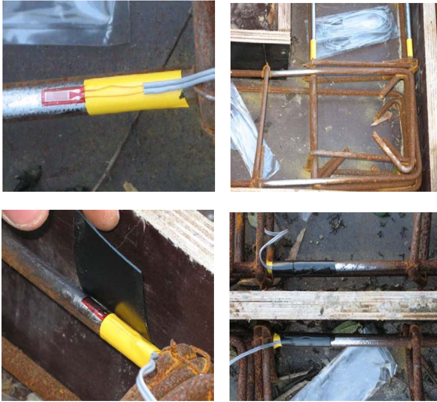
Şekil 2.5 : Donatı üzerine şekil değiştirme ölçer yapıştırılması.
