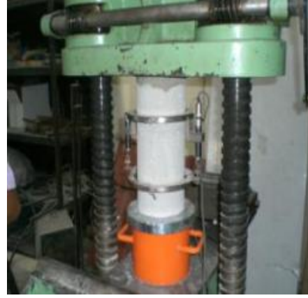
Şekil 2.15 : Standart beton basınç deney sonuçları ve düzeneği.
