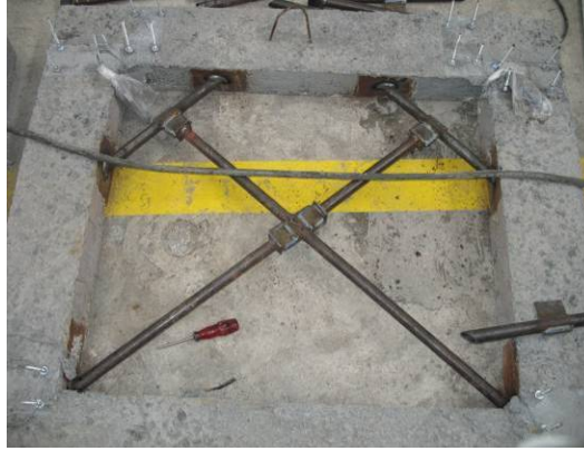
Şekil 2.6 : Çelik çaprazların imalatı.
