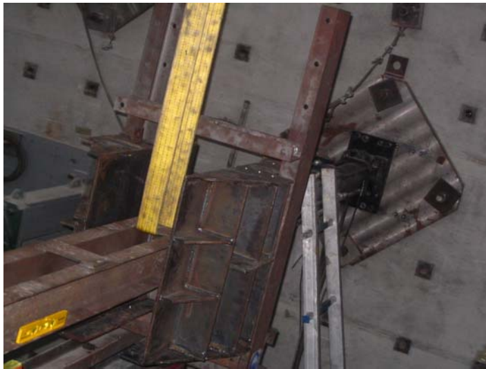
řekil 4.12 : Ykleme sistemine ait yatay ve dřey dzlem dıřı destek sistemi.
