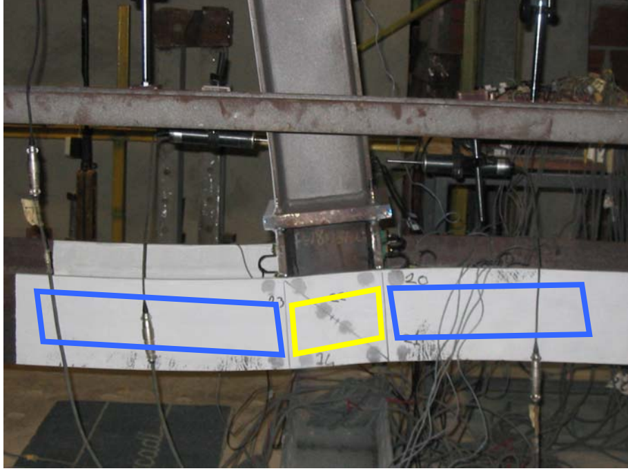
Şekil 5.75 : Kolon-kiriş bölgesinde %10 göreceli ötelemedeki şekil değiştirmeler.
