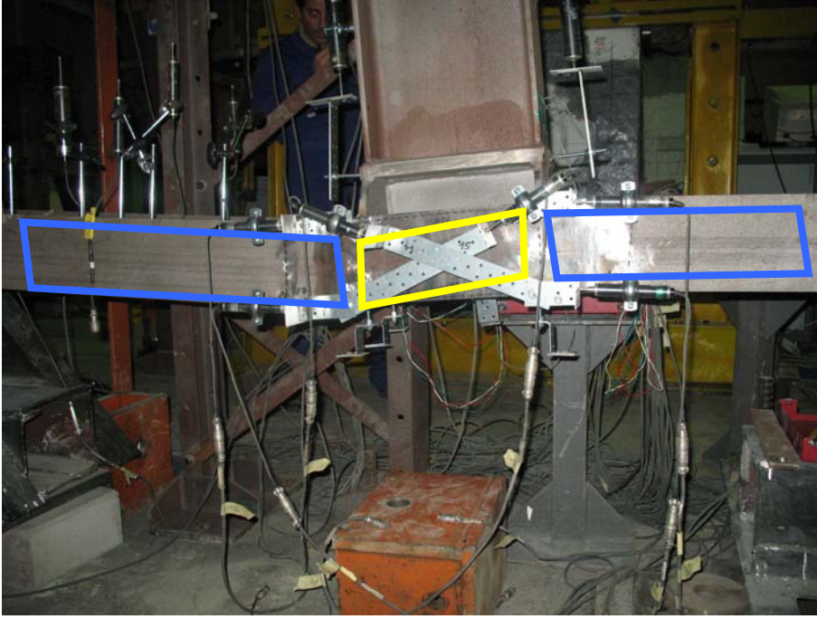
Şekil 5.30 : Kolon-kiriş bölgesinde %10 göreceli ötelemedeki şekil değiştirmeler.
