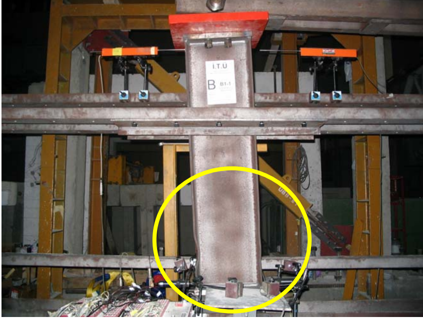
Şekil 5.52 : Kirişte “2 e y ” adımı sırasında plastikleşen bölge ve burkulan başlık.
