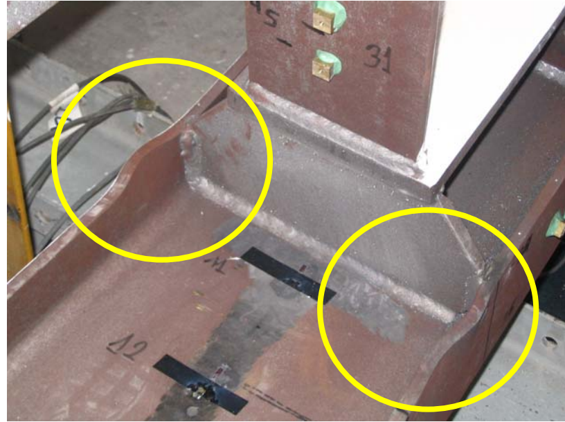
Şekil 5.65 : Kolon başlığında burkulmalar. (Önden)
