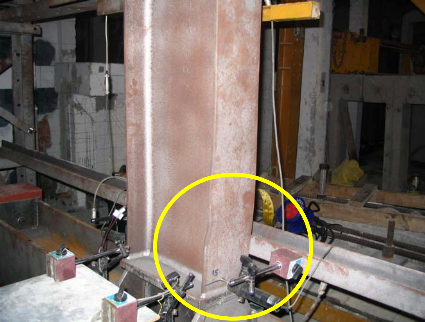
Şekil 5.53 : Kirişte “2 e y ” adımı sırasında plastikleşen bölge ve burkulan başlık.
