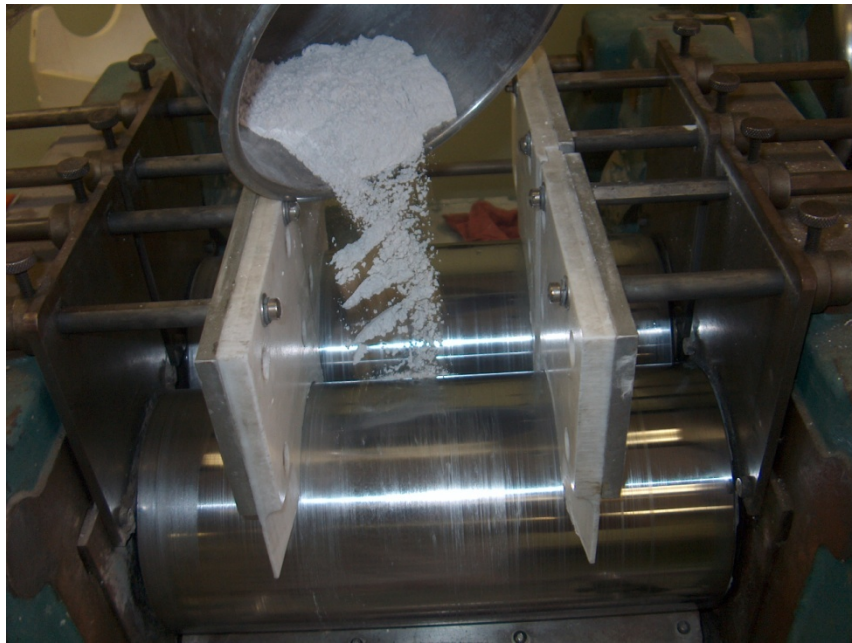
Figure N.1: Processing the materials on roller mills
