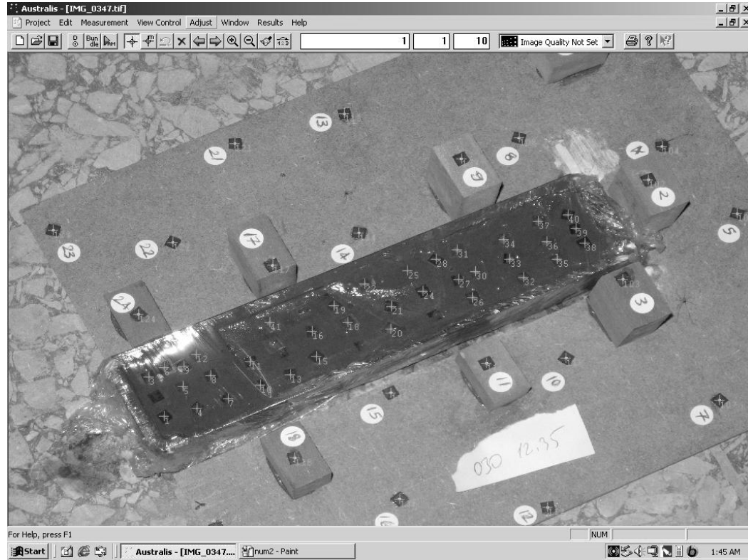
Şekil 3.12: Dijital fotogrametrik sistem için kullanılan numune ve kalibrasyon alanı
