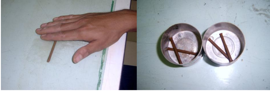
Şekil 7.4: Plastik limit deneyinin yapıışı.
