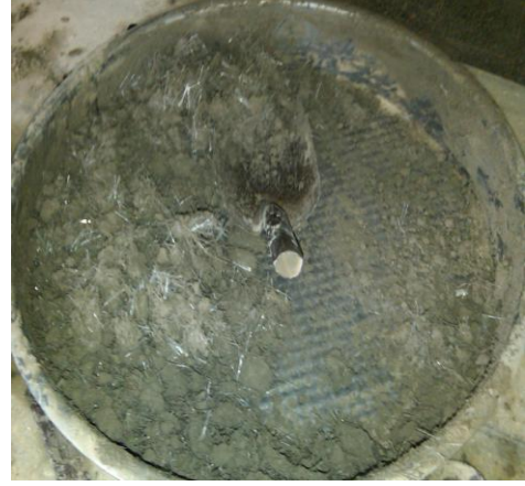
Şekil 7.12 : Kil-uçucu kül ve fiber malzemenin optimum su muhtevasında karıştırılarak hazırlanması.
