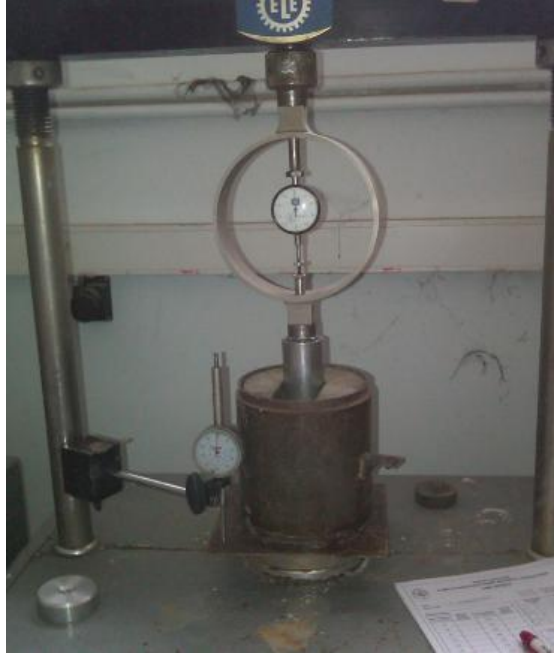
Şekil 7.9 : CBR deneyinin yapılışı.
