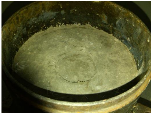
Şekil 7.10 : CBR deneyi sonrası malzeme yüzeyi.
