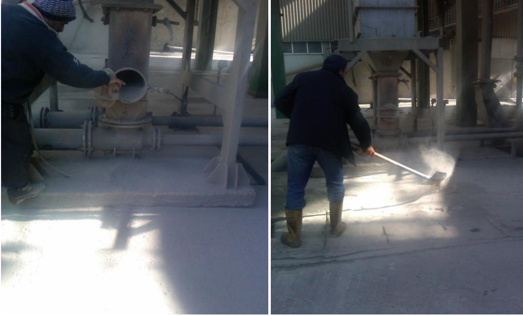
Şekil 4.2 : Çatalağzı termik santrali, uçucu kül numunesi alınması.
