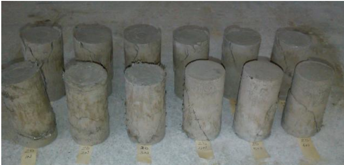
Şekil 7.16 : Serbest basınç deneyi sonrası numunelerin görünüşü.
