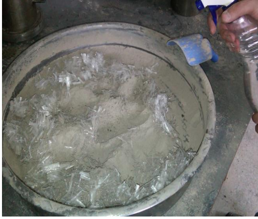
Şekil 7.12 : Kil-uçucu kül ve fiber malzemenin optimum su muhtevasında karıştırılarak hazırlanması.
