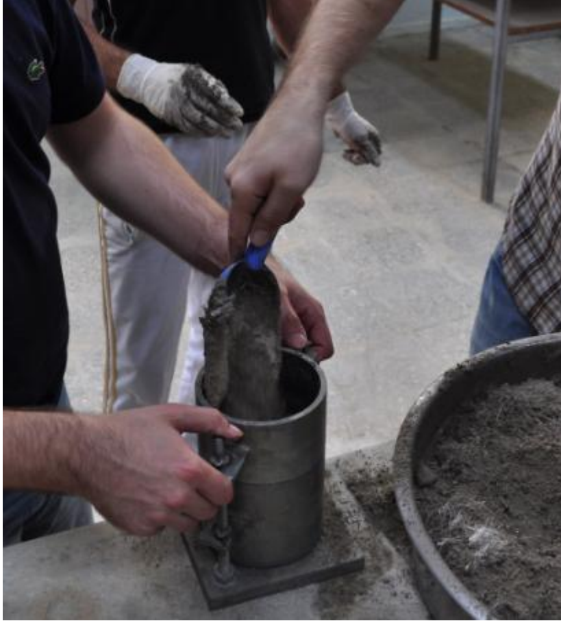
Şekil 7.8 : Laboratuvarda standart proktor kalıbının doldurulması.
