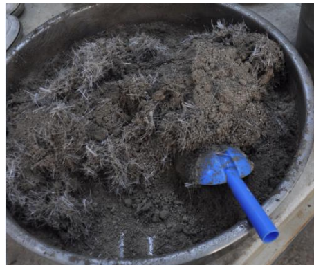
Şekil 9.1 : Karışımın ağırlıkça %2.0’si oranında fiber takviyesiyle hazırlanmış kil-uçucu kül karışımı.
