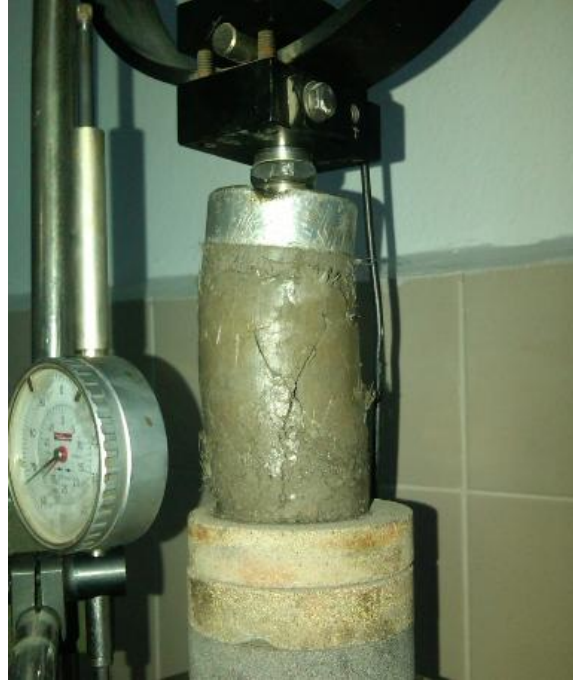
Şekil 7.15 : Serbest basınç deneyinin yapılışı.
