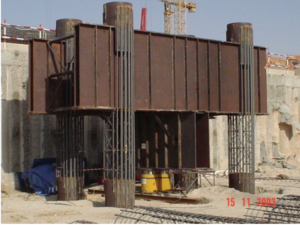
Şekil 5.2 : Statik kazık yükleme deney düzeneği ( ZETAŞ katalog, 2011)
