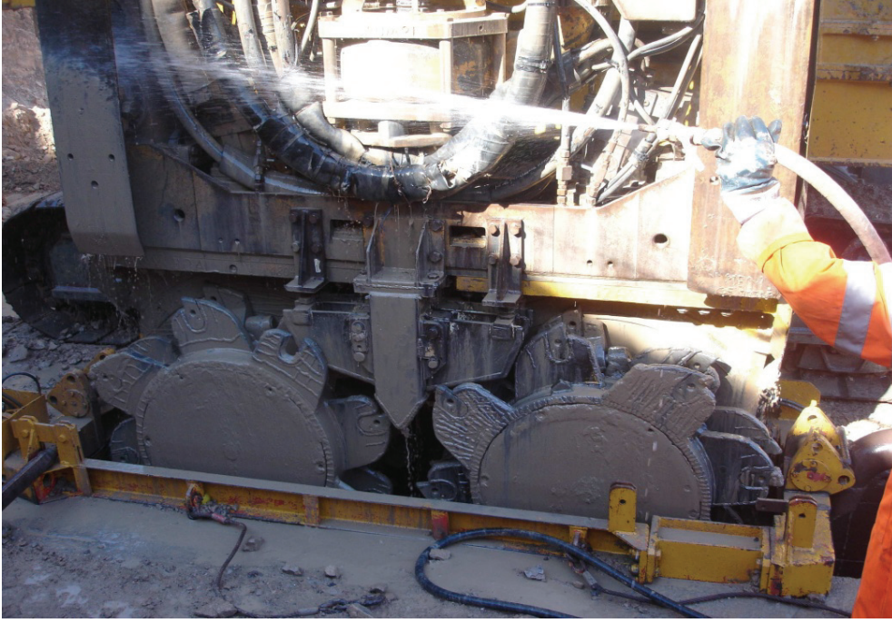
Şekil 4.4 : Hidrofreze (ZETAŞ katalog, 2011)
