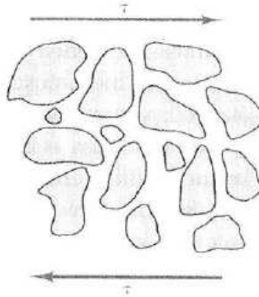
Şekil 3.10 : Zemin danelerinin birbirine göre dönme ve kayması (Coduto, 2006).
