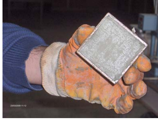
Şekil 4.5 : Tekrarlı kesme kutusu deney numunesinin hazırlanması
