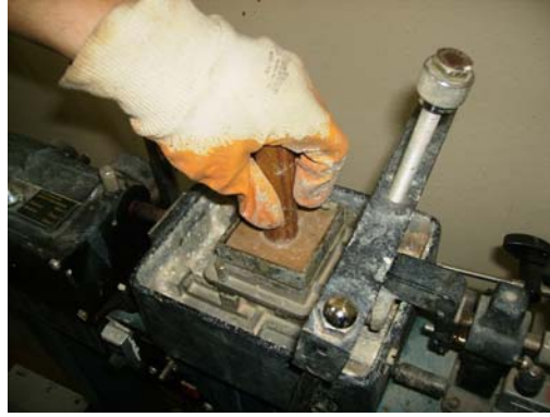
Şekil 4.11 : Numunenin kesme kutusuna yerleştirilmesi
