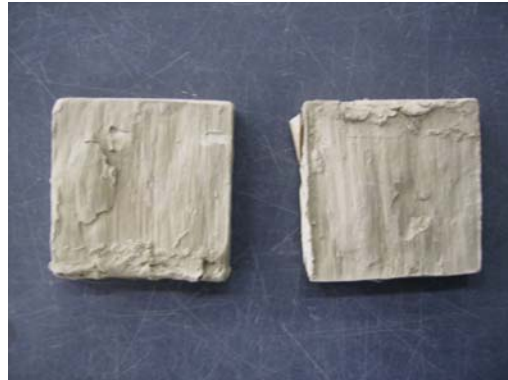
Şekil 4.21 : Etüvde kurutulduktan sonraki kesilmiş yüzeyler
