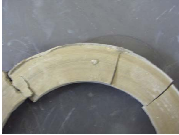
Şekil 3.13 : Halka kesme deney aletide kesilmiş bir numune
