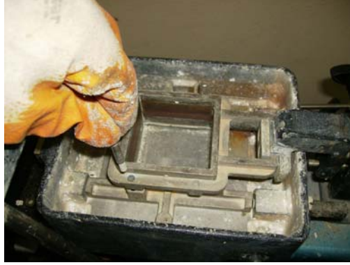
Şekil 4.8 : Alt ve üst parçaların vidalar yardımıyla birbirine tutturulması
