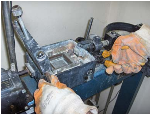
Şekil 4.7 : Kesme kutusu alt ve üst parçalarının yerleştirilmesi
