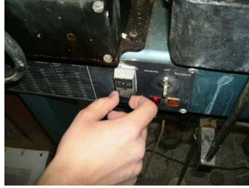
Şekil 4.16 : Vitesin ve kesme hızının ayarlanması
