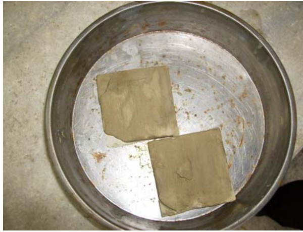
Şekil 3.11 : KESME KUTUSU DENEY ALETİNDE KESİLEN BİR NUMUNE
