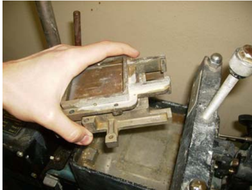
Şekil 4.18 : Numunenin alt ve üst parçayla birlikte sistemden çıkarılması
