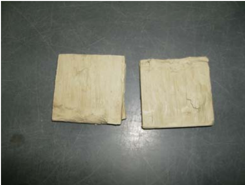
Şekil 4.21 : Etüvde kurutulduktan sonraki kesilmiş yüzeyler
