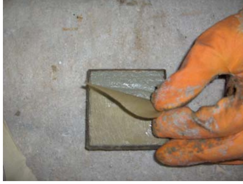
Şekil 4.10 : Numuneye poroz kağıt yerleştirilmesi
