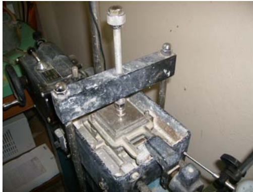
Şekil 4.12 : Normal gerilmeyi numuneye alttan ve üstten gerilmeyi iletecek kısım
