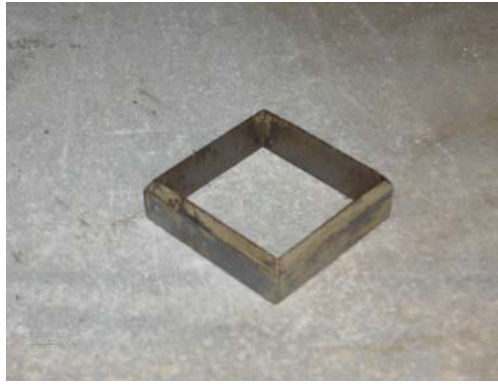
Şekil 4.4 : Uygun boyutlarda numune hazırlamaya yarayan kalıp
