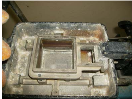
Şekil 4.7 : Kesme kutusu alt ve üst parçalarının yerleştirilmesi
