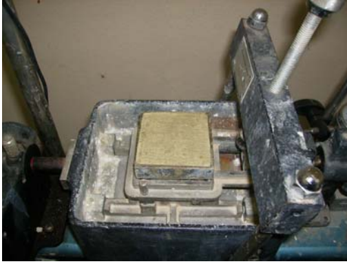
Şekil 4.11 : Numunenin kesme kutusuna yerleştirilmesi
