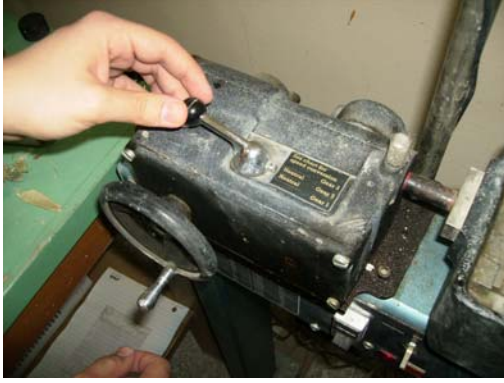
Şekil 4.16 : Vitesin ve kesme hızının ayarlanması
