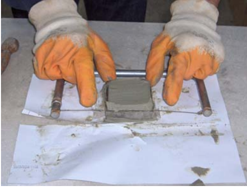
Şekil 4.5 : Tekrarlı kesme kutusu deney numunesinin hazırlanması
