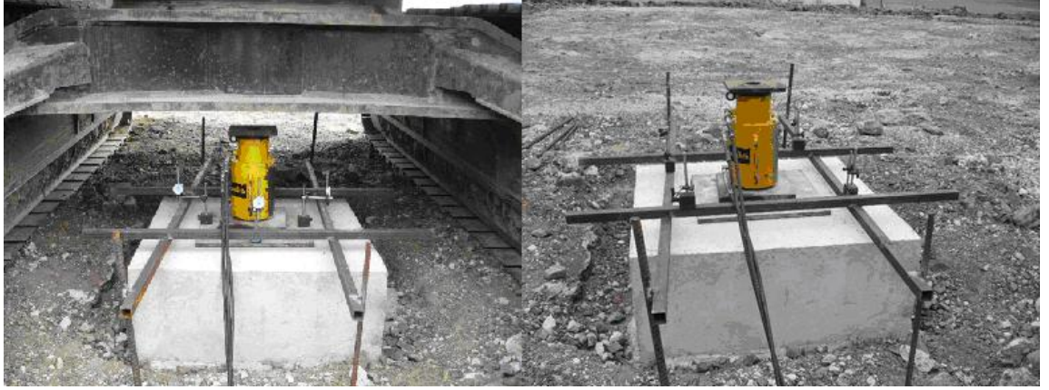
Şekil 4.2 : Deney düzeneğinin hazırlanışı ve deneye başlamaya hazır haldeki konum Jetgrout kolonunun taşıma gücünün tahmini için yapılan kolon yükleme deneyi için hedeflenen taşıma gücü yükü kademe kademe yüklenmiştir.
