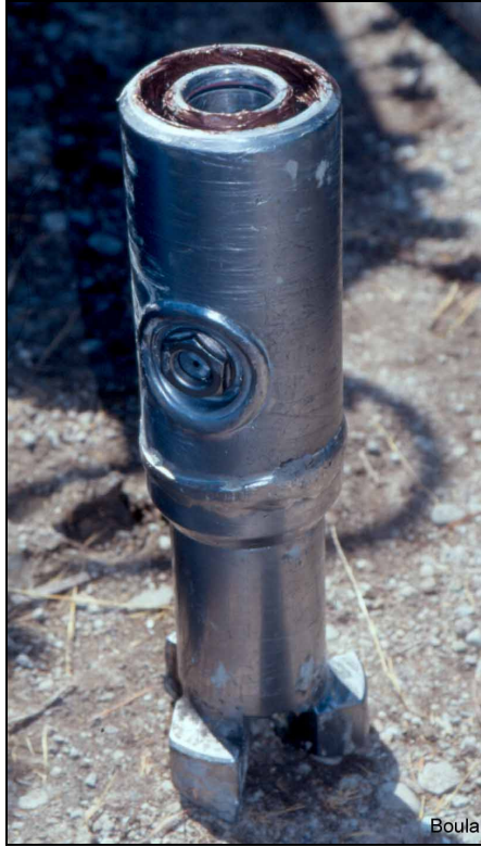
Şekil 3.21: Delme başlığı ve jet enjeksiyon çıkış delikleri (Monitor, nozul)
