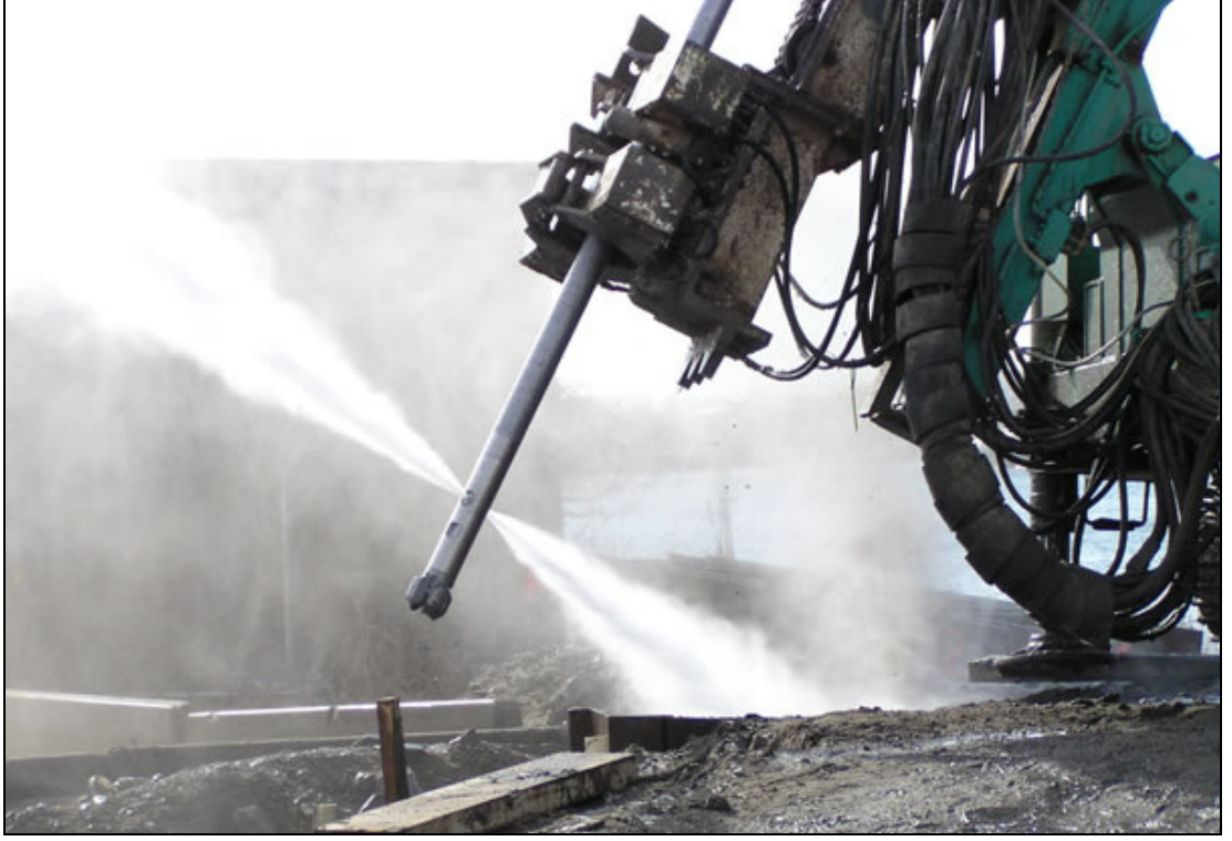
Şekil 3.22: Monitör ve nozuldan basınçlı su çıkışı
