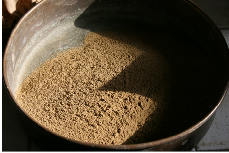
Şekil 6. 2 : Kıvam limitleri deneyi için hazırlanan numune
