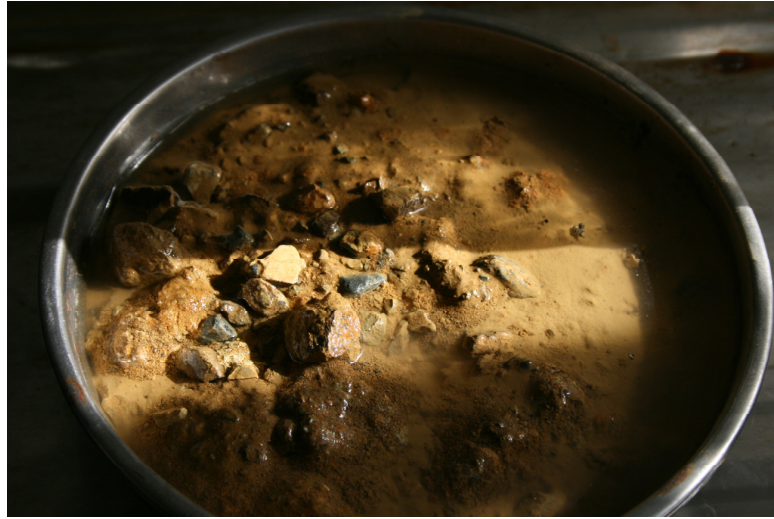
Şekil 6. 3 : Yıkanan dolgu malzemesi
