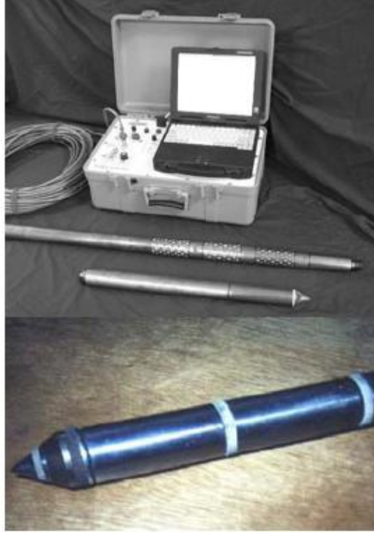
Şekil 3.4 : Elektronik CPTu ve şematik kesiti (NCHRP Synthesis 368, 2007).
