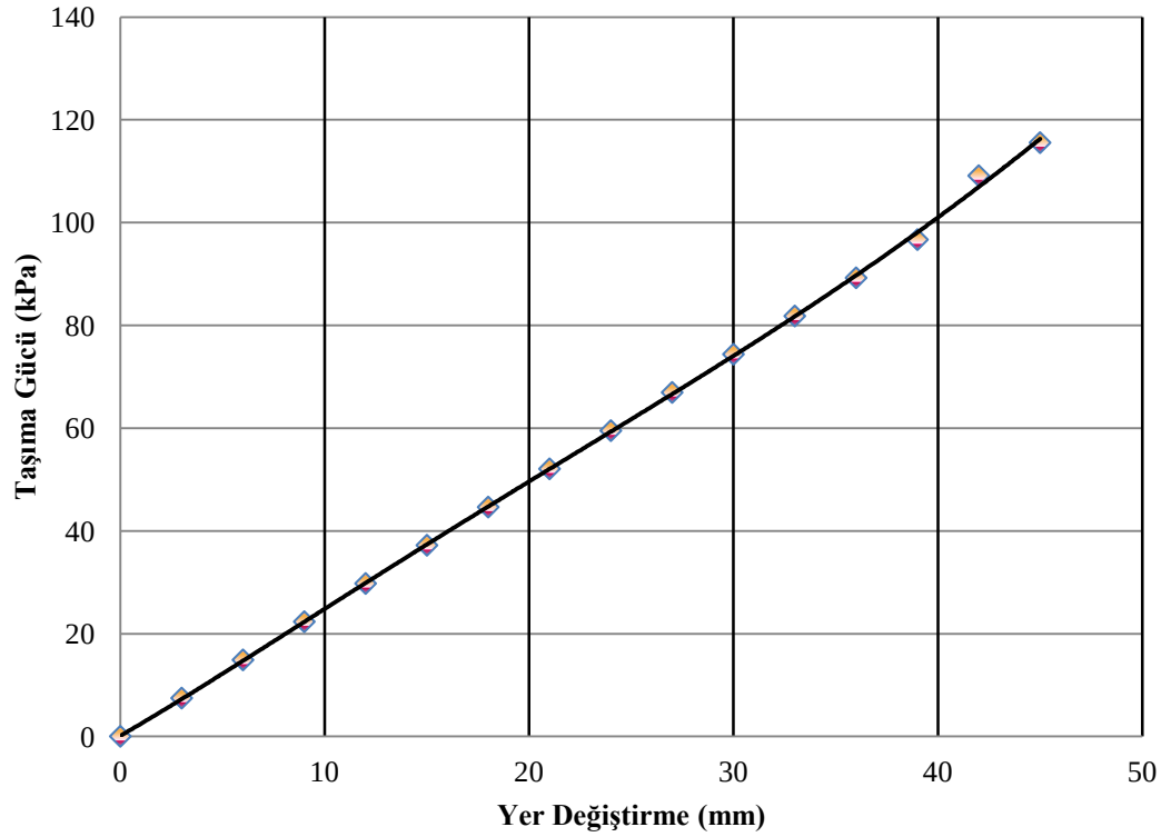
Şekil E. 16 : Numune II' e ait şerit DOZ modelinin taşıma gücü & yer değiştirme grafiği YASS B
