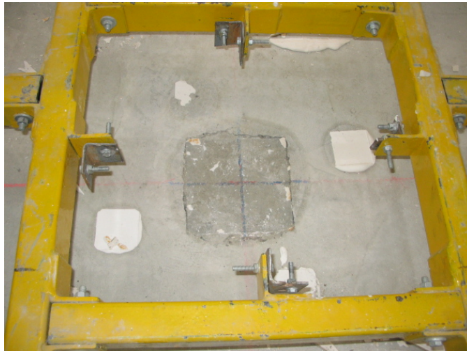
Şekil 7.15: P12 Plağı Yükleme Sonrası Orta Noktasının Görünümü
