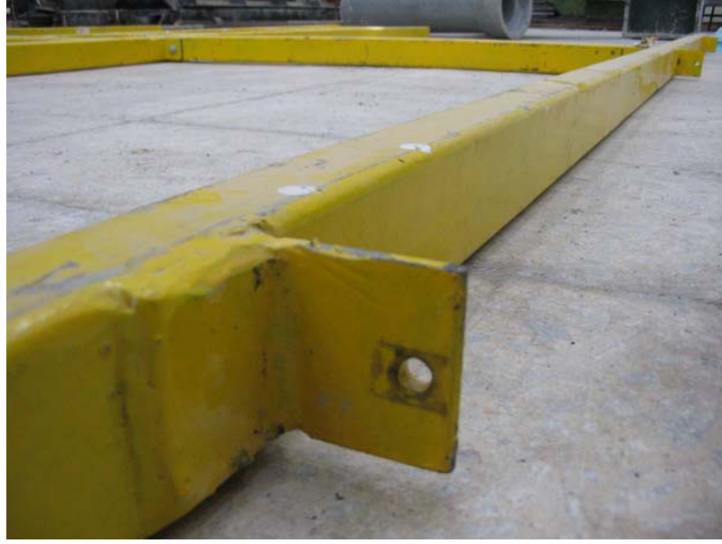
Şekil 5.8: Transducer Bağlantı Noktası Detayı
