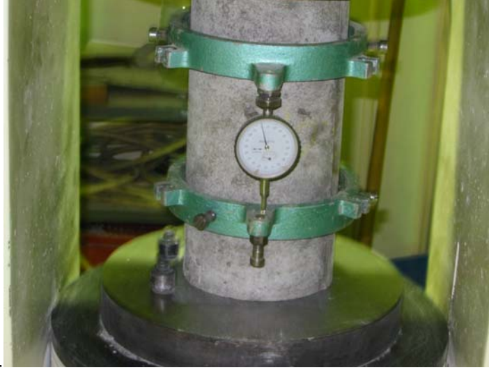
Şekil 5.18: Beton Silindir Numunesinin Basınç Dayanımı Deneyi
