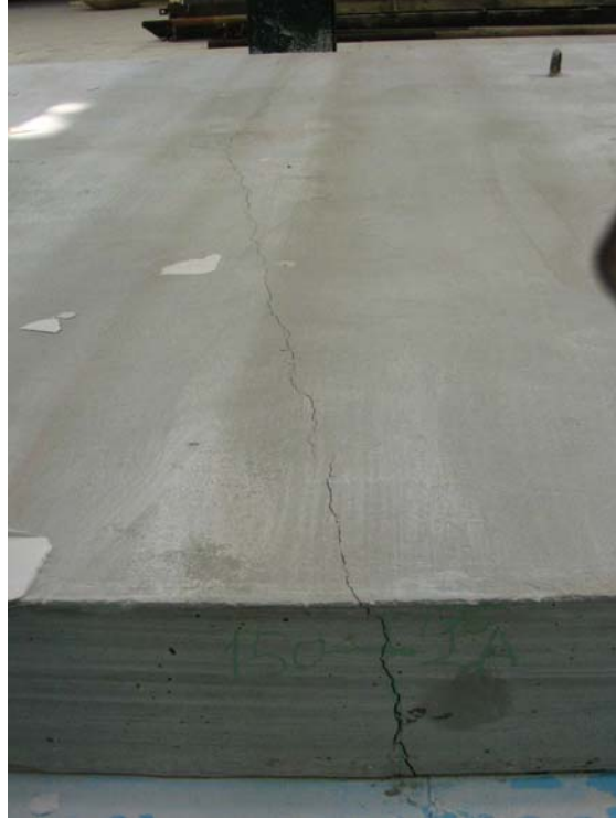
Şekil 7.7: P11 Plagi Üst Yüzeyinin Çatlak Doğrultusu
