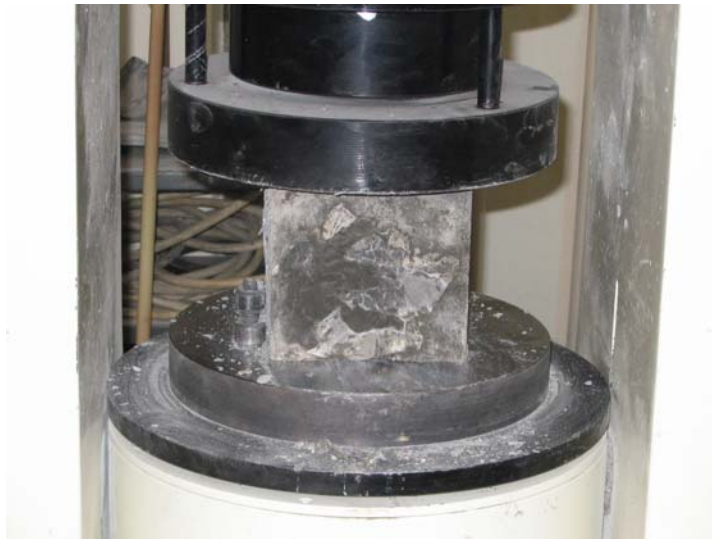
Şekil 5.17: Beton Küp Numunesinin Basınç Dayanımı Deneyi
