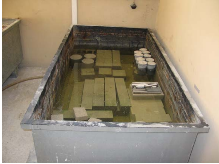
Şekil 5.16: Havuz İçerisindeki Sertleşmiş Beton Deneyi Numuneleri
