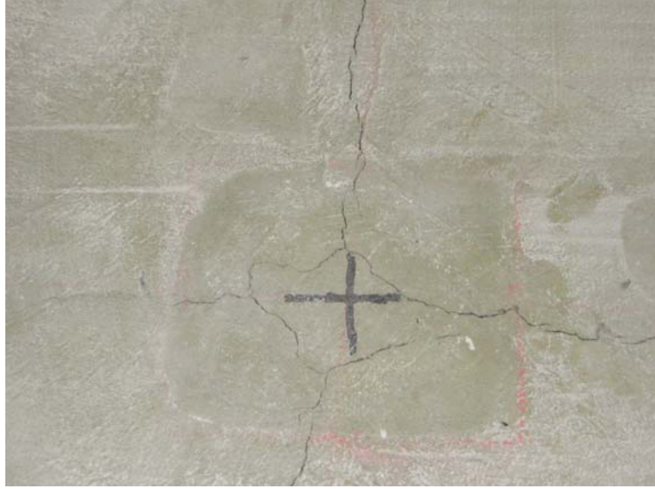
Şekil 7.8: P11 Plağı Yükleme Sonrası Orta Noktasının Görünümü
