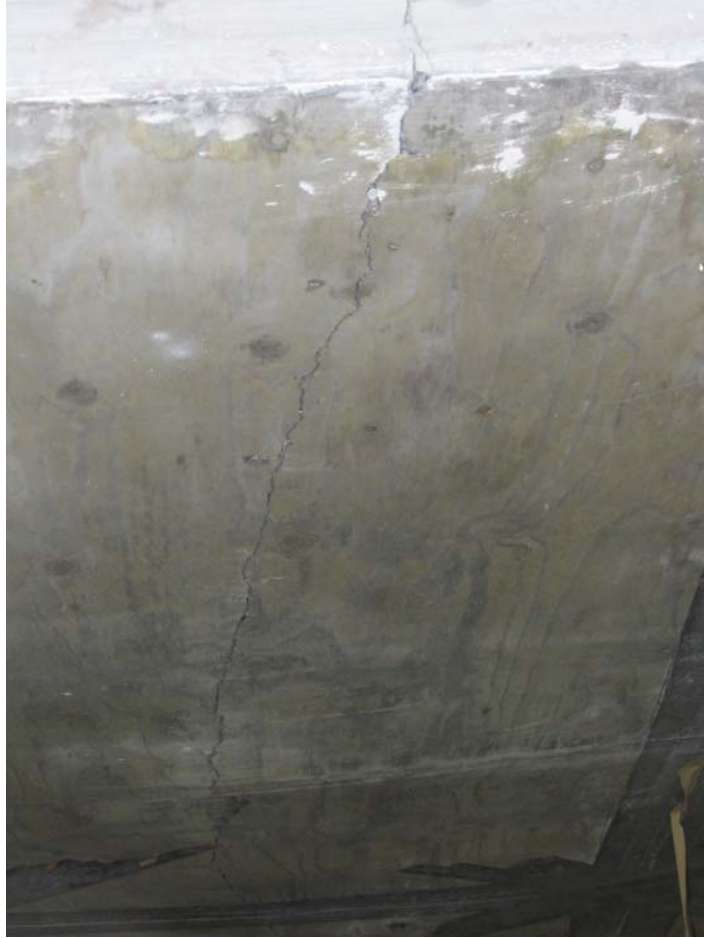
Şekil 7.9: P11 Plağının Alt Yüzeyinin Kırılma Sonrası Görünümü
