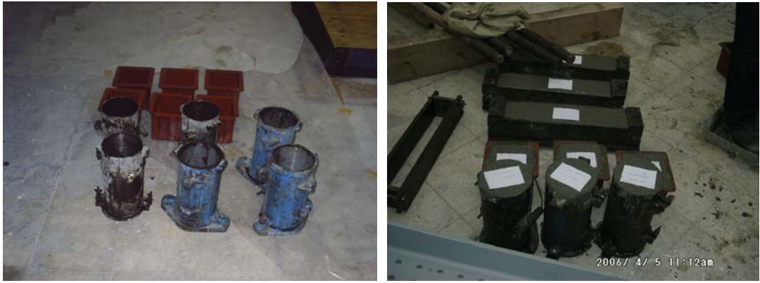
Şekil 5.15: Beton Dökümü Öncesi Mekanik Deneyler İçin Hazırlanan Kalıplar
