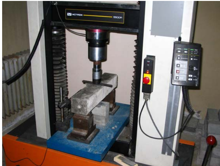
Şekil 5.19: Beton Kiriş Numunesinin Eğilme Dayanımı Deneyi
