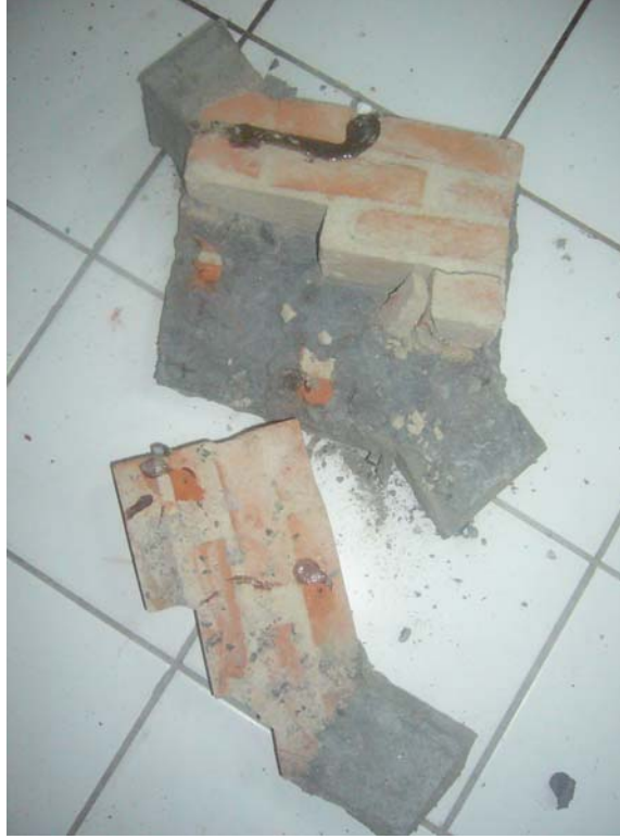
Şekil 4.22 : Standart Beton İle Takviye Edilmiş Tuğla Duvar Numunesi
