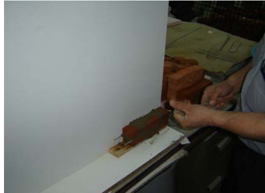
Şekil 3.8 : Tuğla Numunesinin Hazırlanışı
