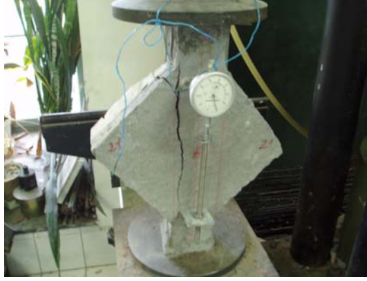
Şekil 3.27 : Kendiliğinden Yerleşen Beton İle Takviye Edilmiş Model Tuğla Duvarın Yüklenme Sonrası Hasar Meydana Gelmiş Hali Ön Yüzü
