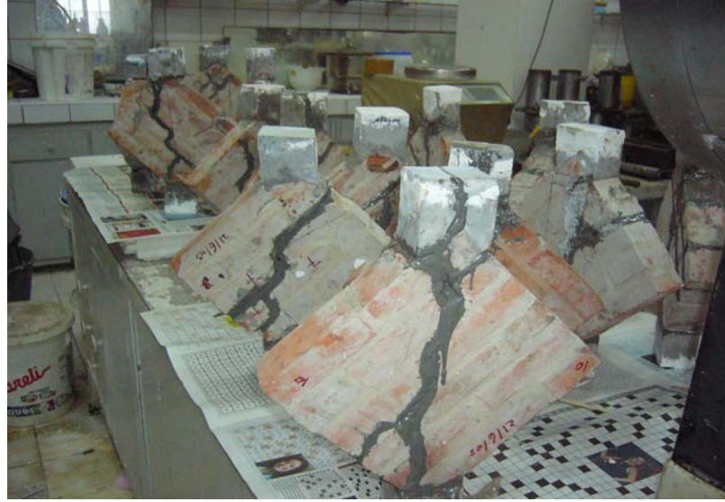
Şekil 3.15 : Epoksi İle Tamir Görmüş Model Tuğla Duvar Numuneleri
