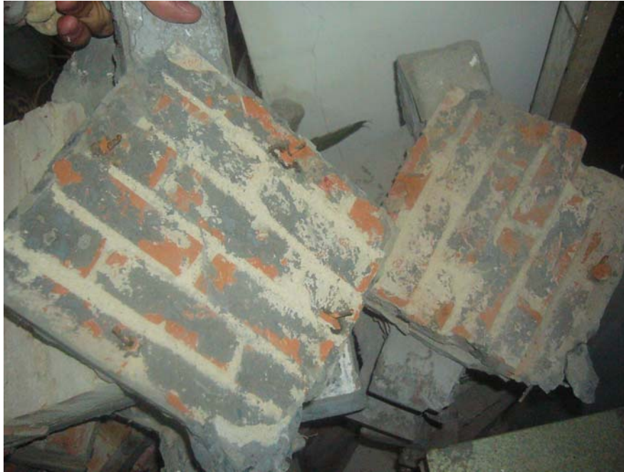
Şekil 4.23 : Kendiliğinden Yerleşen Beton İle Takviye Edilmiş Tuğla Duvar Numunesi
