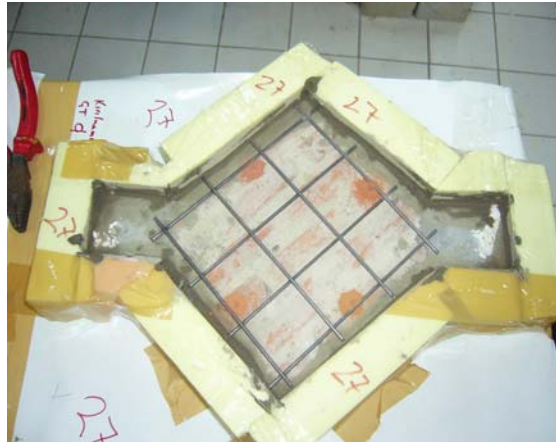
Şekil 3.18 : Donatısı Hazırlanmış Model Tuğla Duvar Numunesi
