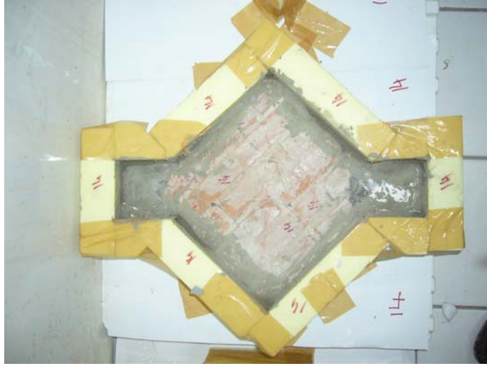
Şekil 3.17 : Kalıbı Hazırlanmış Model Tuğla Duvar Numunesi
