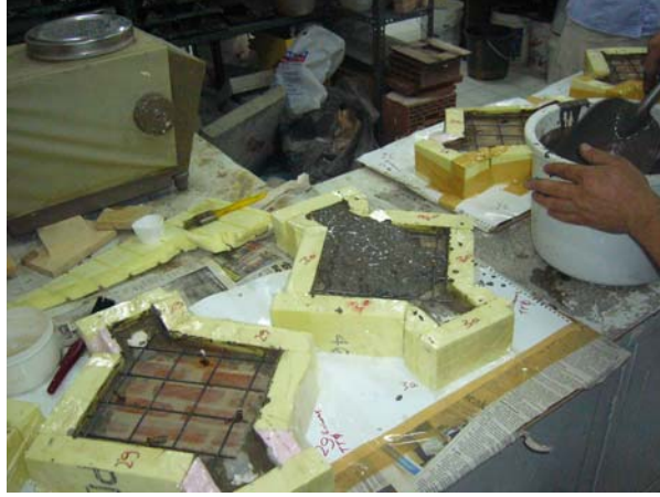
Şekil 3.19 : Model Tuğla Duvarların Tek Yüzlerinin Kendiliğinden Yerleşen Beton İle Takviye Edilişi
