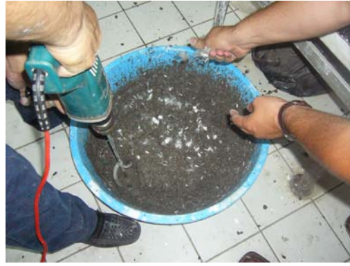
Şekil 3.21 : Kendiliğinden Yerleşen Betona Polipropilen Lif Katılması
