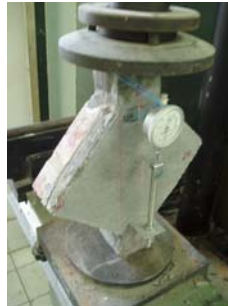
Şekil 3.26 : Kendiliğinden Yerleşen Beton İle Takviye Edilmiş Model Tuğla Duvarın Yüklenmesi
