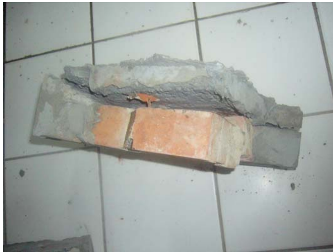
Şekil 3.29 : Standart Beton İle Takviye Edilmiş Model Tuğla Duvarın Yüklenme Sonrası Hasar Meydana Gelmiş Hali
