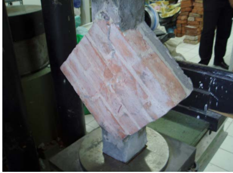
Şekil 3.13 : Model Tuğla Duvar Numunesinin Yüklenmesi
