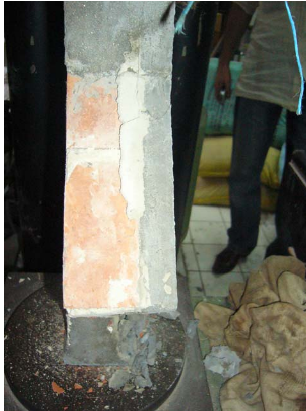
Şekil 4.25 : Kendiliğinden Yerleşen Beton İle Takviye Edilmiş Tuğla Duvar Numunesi
