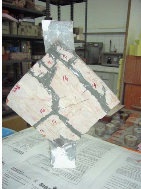
Şekil 3.16 : Epoksi İle Tamir Görmüş Model Tuğla Duvar Numunesi
