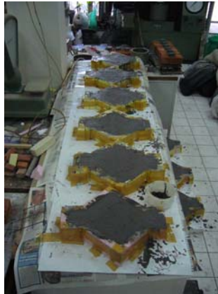
Şekil 3.22 : Polipropilenli Kendiliğinden Yerleşen Beton İle Takviye Edilmiş Model Duvar Numuneleri
