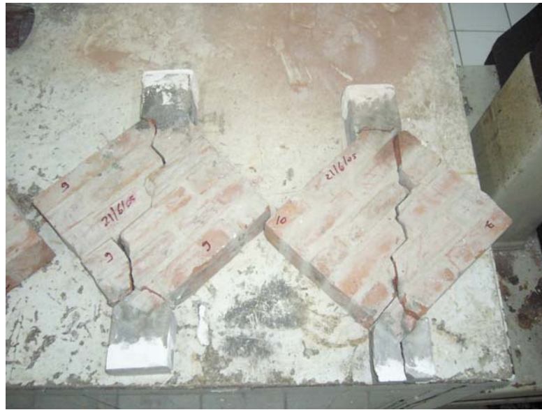
Şekil 3.14 : Hasar Meydana Gelmiş Model Tuğla Duvar Numuneleri
