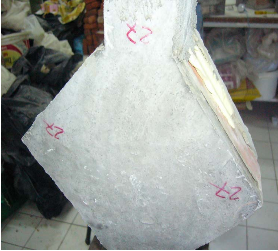
Şekil 4.21 : Kendiliğinden Yerleşen Beton ile Takviye Edilmiş Tuğla Duvar Numunesi
