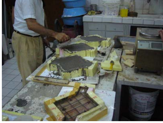
Şekil 3.23 : Model Tuğla Duvarların İkinci Yüzünün Kendiliğinden Yerleşen Beton İle Takviye Edilmesi
