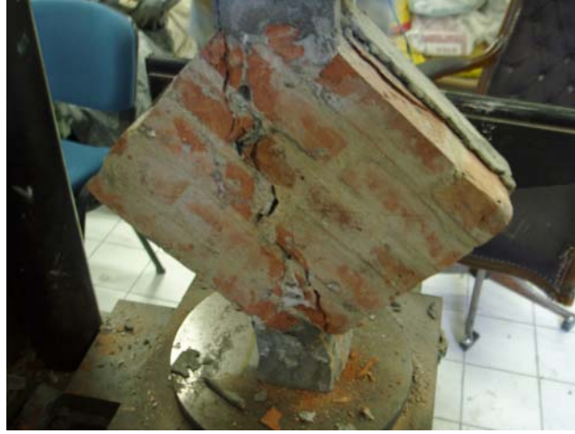
Şekil 3.27 : Kendiliğinden Yerleşen Beton İle Takviye Edilmiş Model Tuğla Duvarın Yüklenme Sonrası Hasar Meydana Gelmiş Hali Ön Yüzü
