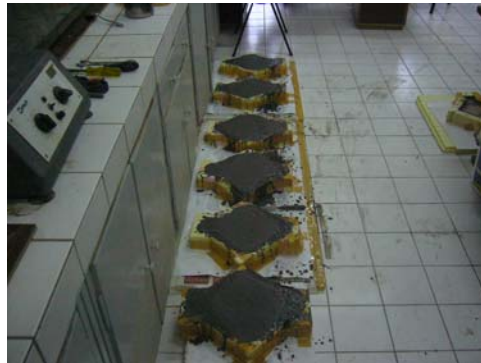
Şekil 3.20 : Kendiliğinden Yerleşen Beton İle Takviye Edilmiş Model Tuğla Duvarlar
