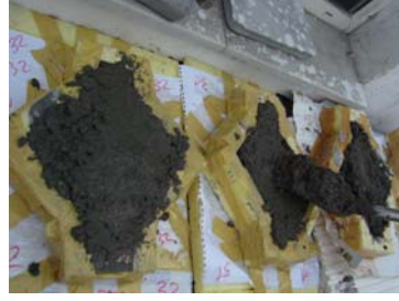
Şekil 3.25 : Model Tuğla Duvarların İkinci Yüzlerinin Standart Beton İle Takviye Edilişi
