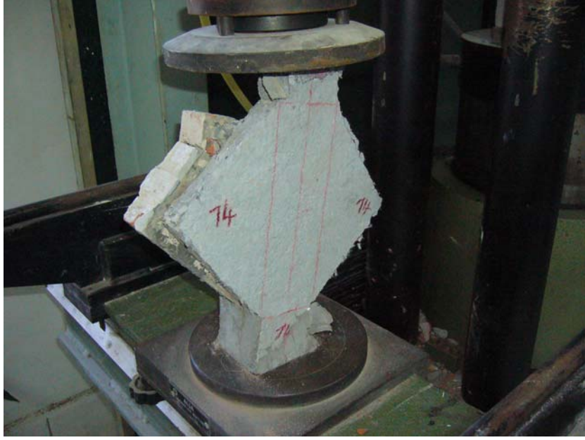
Şekil 4.26 : Takviye Edilmiş Tuğla Duvar Numunesi
