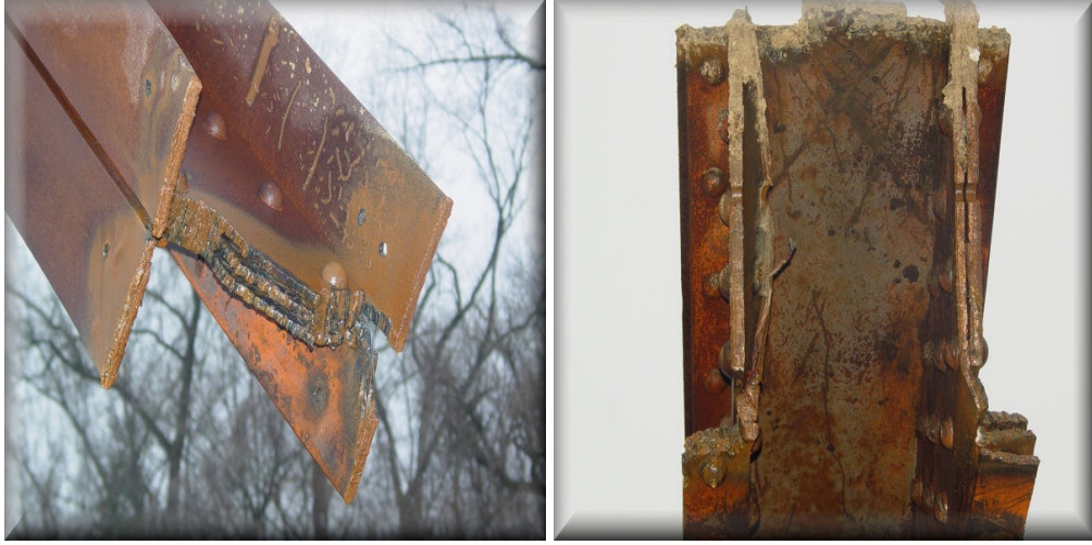
Şekil 8.14 : Patlayıcıların Çelik Elemanı Kesmesi
