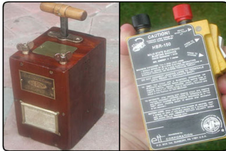
Şekil 3.8 : Patlatmalı Yapı Yıkım Çalışmalarında Kullanılan Manyeto Örnekleri
