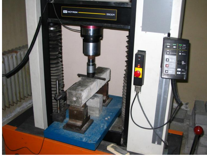
Şekil 5.19: Beton Kiriş Numunesinin Eğilme Dayanımı Deneyi
