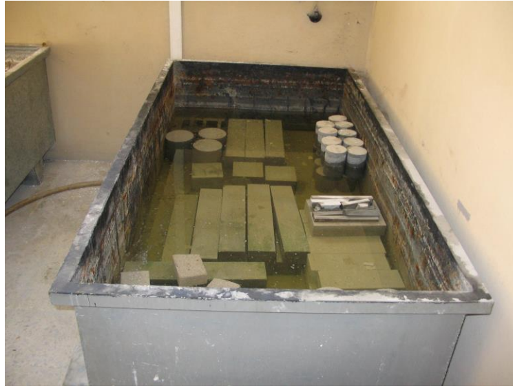
Şekil 5.16: Havuz İçerisindeki Sertleşmiş Beton Deneyi Numuneleri
