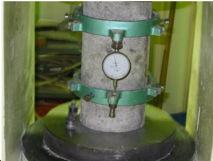
Şekil 5.18: Beton Silindir Numunesinin Basınç Dayanımı Deneyi
