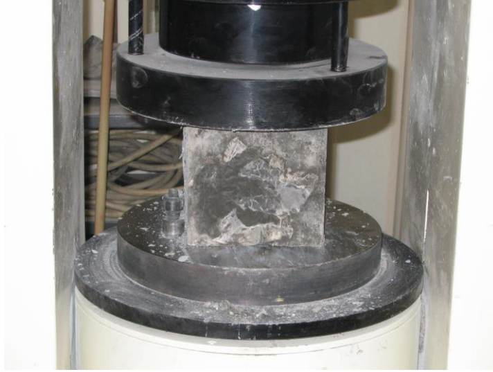
Şekil 5.17: Beton Küp Numunesinin Basınç Dayanımı Deneyi
