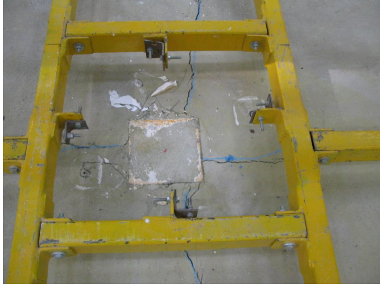
Şekil 7.22: P7 Plağı Yükleme Sonrası Orta Noktanın Görünümü
