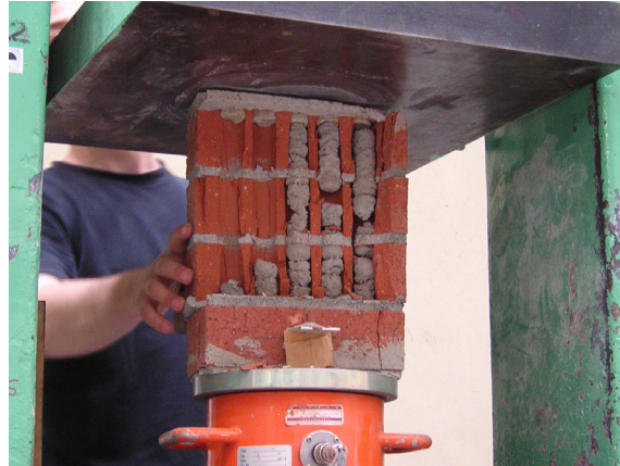
Şekil 6.11 PT 4S 03 Numunesi Göçme Biçimi
