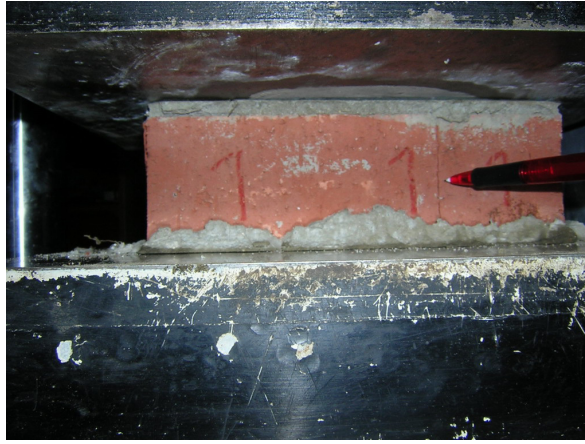
Şekil 4.5 Numune #1 de Ulaşılan Göçme Biçimi
