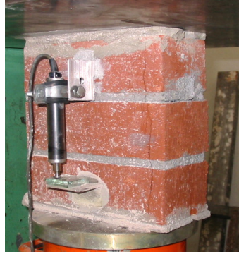
Şekil 6.5 PT 3S 03 Numunesi Göçme Biçimi
