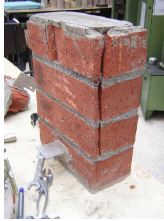
Şekil 6.10 PT 4S 02 Numunesi Göçme Biçimi
