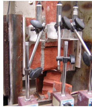
Şekil B.6 PTK 100 01 Numunelerinin Göçme Biçimleri
