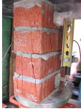
Şekil 6.13 PT 4S 04 Numunesi Göçme Biçimi
