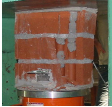
Şekil 6.8 PT 3S 05 Numunesi Göçme Biçimi
