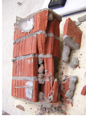
Şekil 6.14 PT 4S 05 Numunesi Göçme Biçimi
