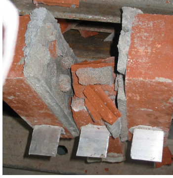
Şekil 7.5 PTK 000 02 Ve PTK 000 04 Numunelerinin Göçme Biçimi
