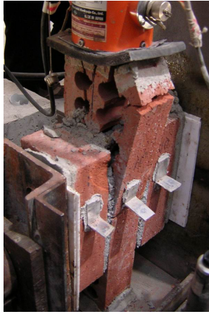
Şekil 7.6 PTK 020 01 ve PTK 020 02 Numunelerinin Göçme Biçimleri
