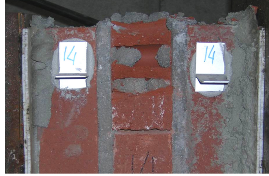
Şekil B.4 PTK 040 01 ve PTK 040 02 Numunelerinin Göçme Biçimleri
