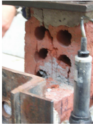
Şekil 7.7 PTK 030 02 ve PTK 030 03 Numunelerinin Göçme Biçimleri
