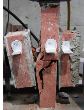
Şekil 7.5 PTK 000 02 Ve PTK 000 04 Numunelerinin Göçme Biçimi
