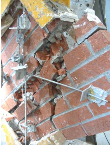
Şekil 8.5 PT 4 20 yük yerdeğiştirme ve gerilme kayma açısı göçme anından hemen önceki hasar durumu
