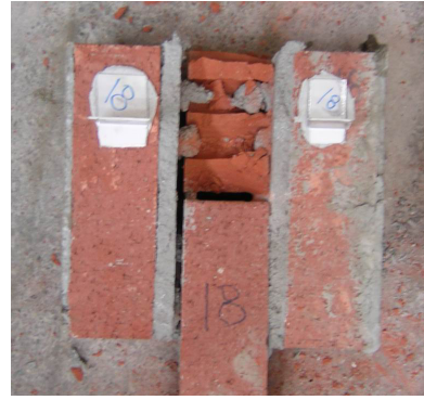
Şekil B.5 PTK 060 01 ve PTK 060 02 Numunelerinin Göçme Biçimleri
