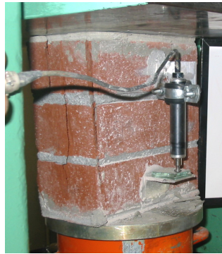
Şekil 6.6 PT 3S 04 Numunesi Göçme Biçimi
