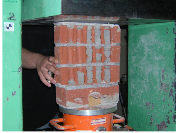
Şekil 6.9 PT 4S 01 Numunesi Göçme Biçimi
