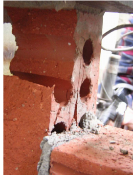
Şekil B.5 PTK 060 01 ve PTK 060 02 Numunelerinin Göçme Biçimleri
