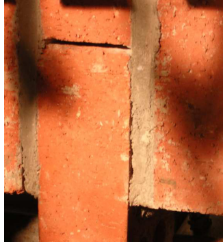
Şekil B.4 PTK 040 01 ve PTK 040 02 Numunelerinin Göçme Biçimleri
