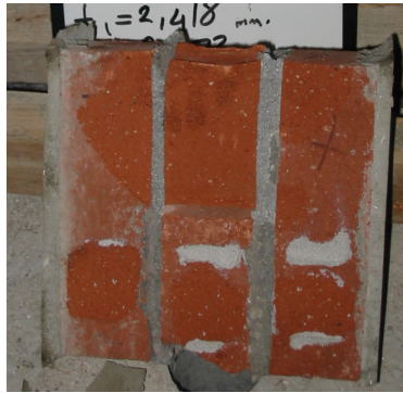
Şekil B.6 PTK 100 01 Numunelerinin Göçme Biçimleri
