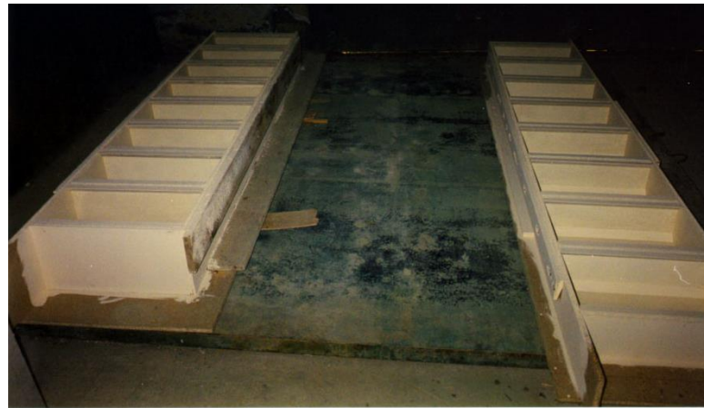
Şekil 2.4 2. ve 3. seri numune üretiminde kullanılan ahşap kalıplar
