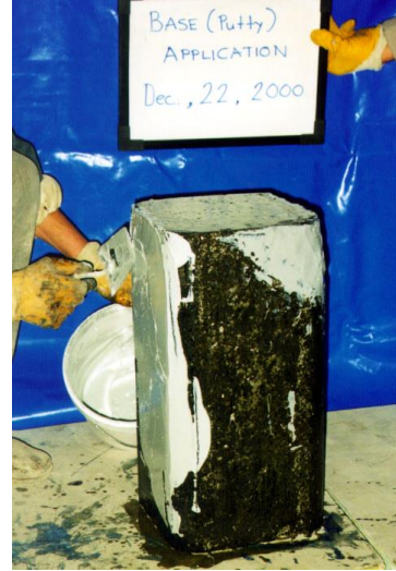
Şekil 3.8 Epoksi esaslı macun karışımının sürülmesi
