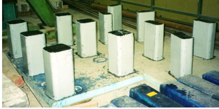
Şekil 3.9 Epoksi esaslı macun karışımı sürülme işlemi bittikten sonraki görünüm
