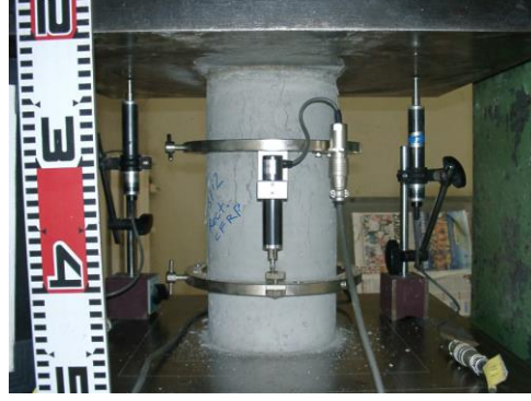
Şekil 2.5 Standart silindir basınç deneyi için hazırlanan düzenek
