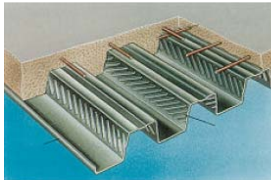
Şekil 2.19 Kompozit döşeme içinde kullanılan trapez eleman (Outinen, 2000)
