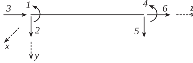
Şekil 3.1: Çubuk koordinatlarında uç serbestlikleri ve yönleri.
