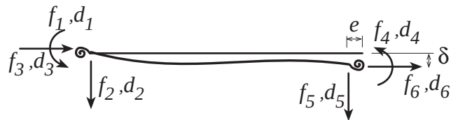
Şekil 5.4: Yarı-Rijit Bağlantılı Kirişte Uç Kuvvetler ve Deplasmanlar
