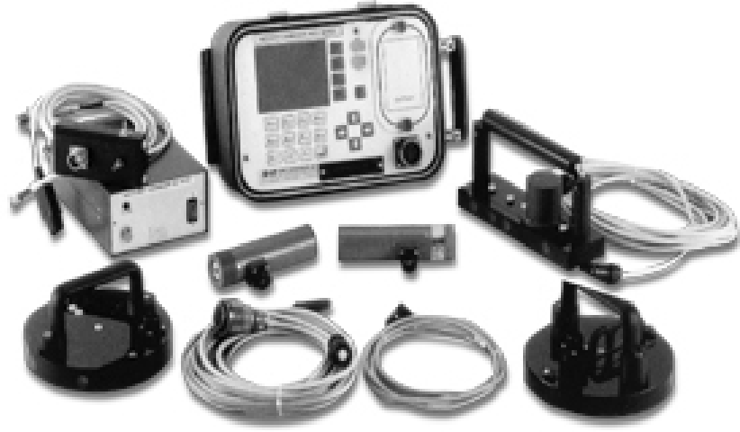
Şekil 3.6 : Korozyon Ölçümlerinde Kullanılan Gecor 8 Cihazı
