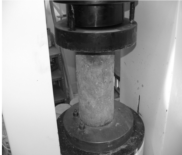
Şekil Ek. 2.: Silindir basınç deneyi düzeneği
