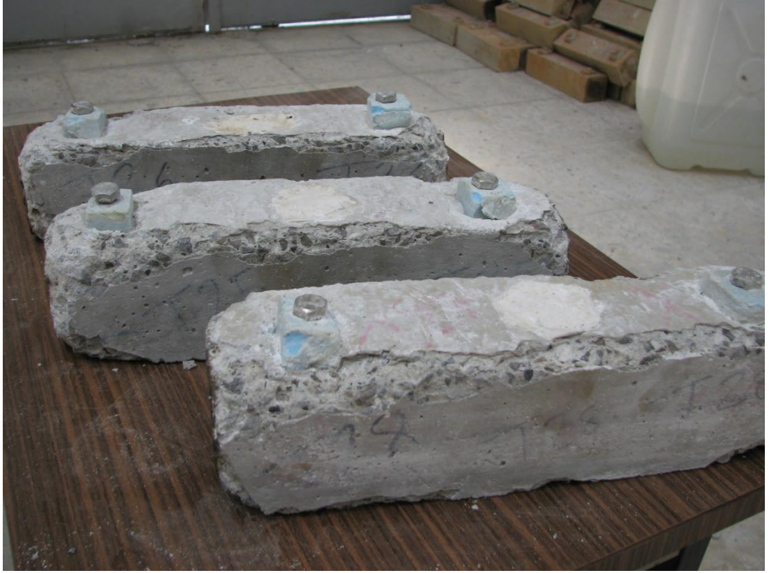
Şekil 5.1: Sülfat Etkisinde Zarar Görmüş CÇ42.5-C25 Numuneleri
