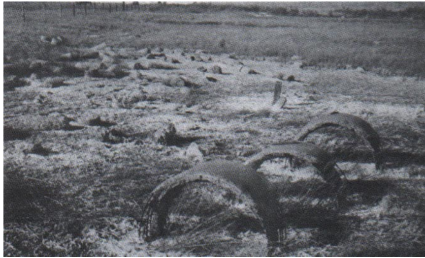
Şekil 2.9: Sülfat etkisiyle beton elemanların hasara uğraması A) Betonarme bir elemanın bozulması B) Sülfatlı bir zemine bırakılan beton boruların bozulması
