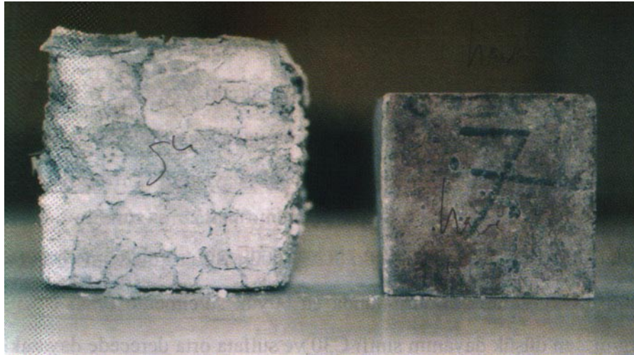
Şekil 2.13: Yüksek Oranda Alçıtaşı (Kalsiyum Sülfat) İçeren Harç Örneklerinin Havada ve Su İçinde Bekletilmeleri Halinde 84 Gün Sonundaki Durumları. Soldaki Ağır Hasarlı Örnek Su İçinde, Sağdaki Örnek İse Havada Bekletilmiştir [55]
