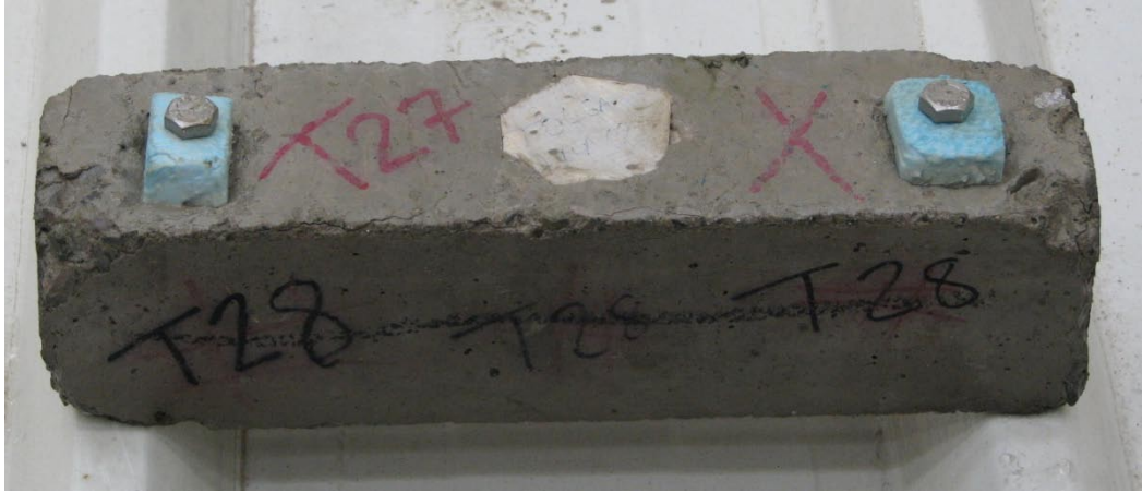
Şekil 5.1: Sülfat Etkisine Maruz Kalmış Beton Numunesi
