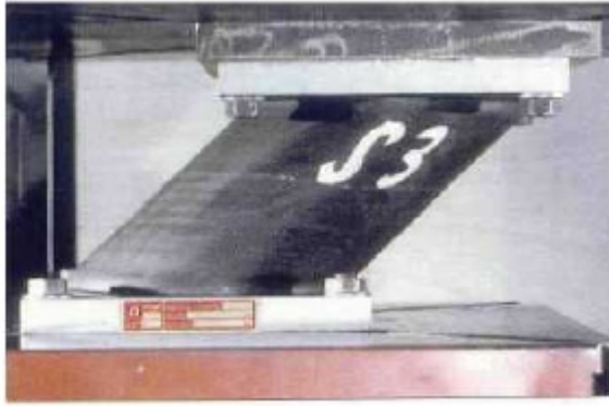
Şekil 3.22: Kauçuk izolatörde şekildeğiştirme [40]
