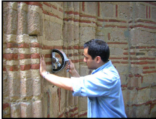
Şekil 2.19: P tipi Schmidt çekici testi uygulaması [36]
