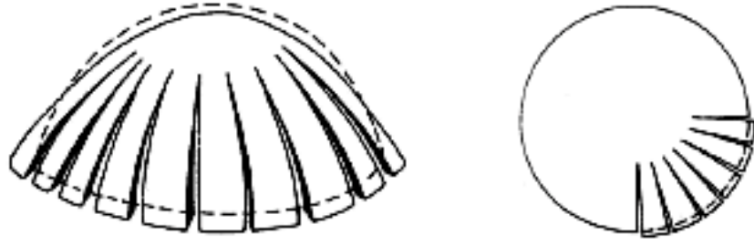
Şekil 2.15: Kubbede tipik hasar biçimleri [26]
