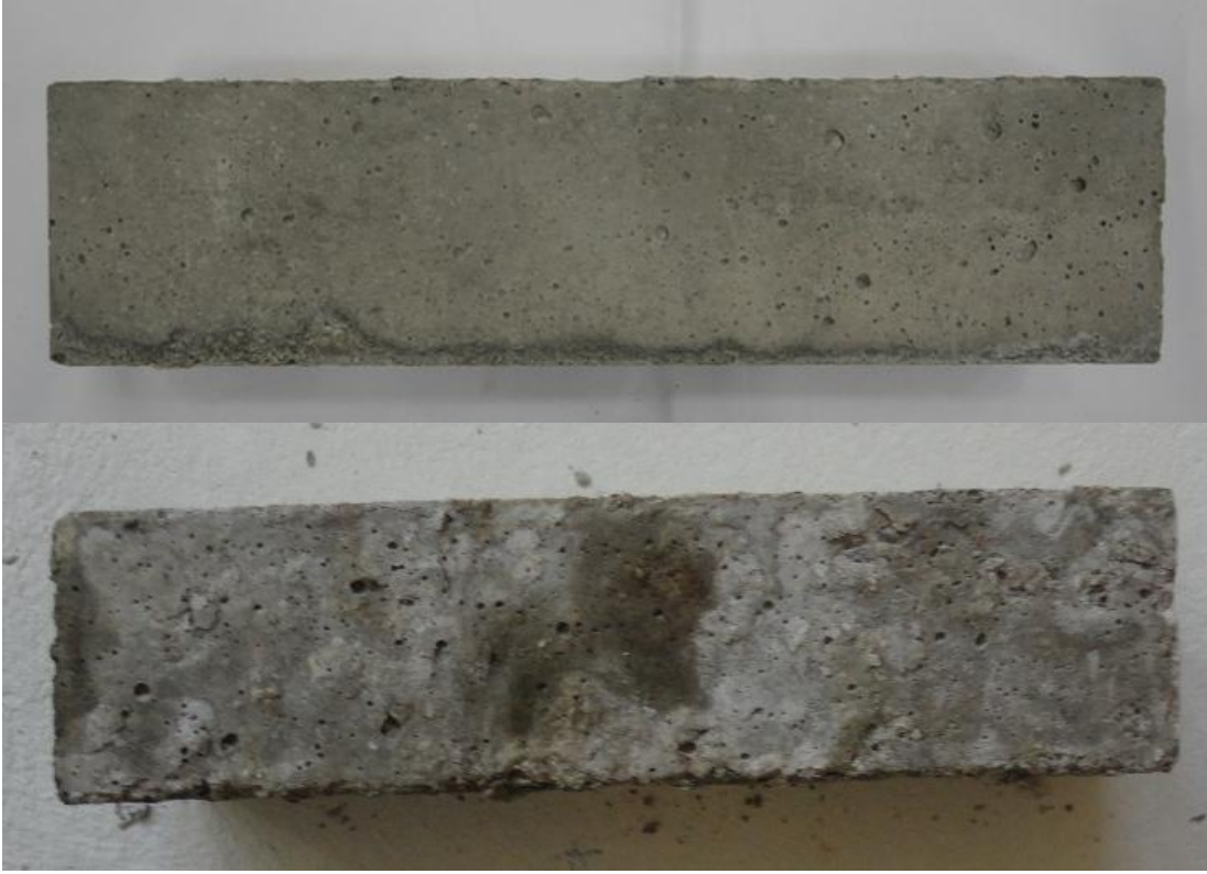
Şekil Ek. 15: K250+70 Numunesine ait magnezyum sülfat etkisinden önceki ve sonraki görüntüler
