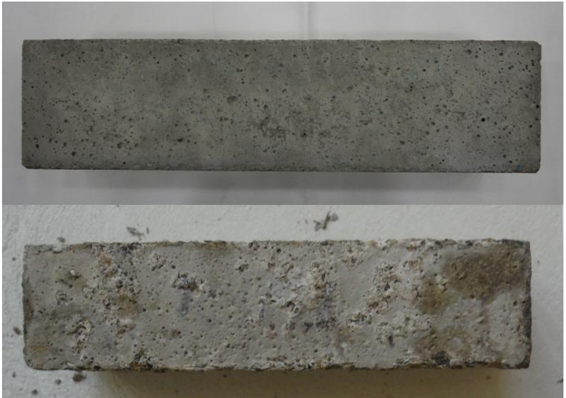
Şekil Ek. 10 : A250+50 Numunesine ait magnezyum sülfat etkisinden önceki ve sonraki görüntüler
