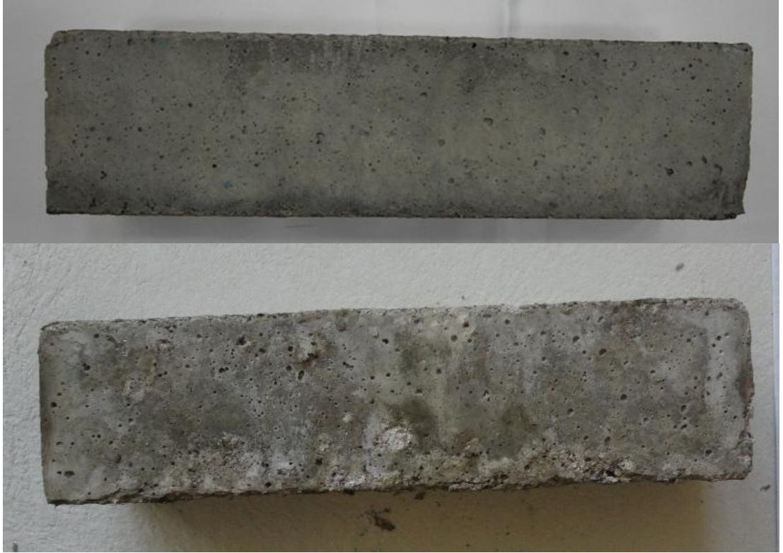
Şekil Ek. 9: R001 Numunesine ait magnezyum sülfat etkisinden önceki ve sonraki görüntüler
