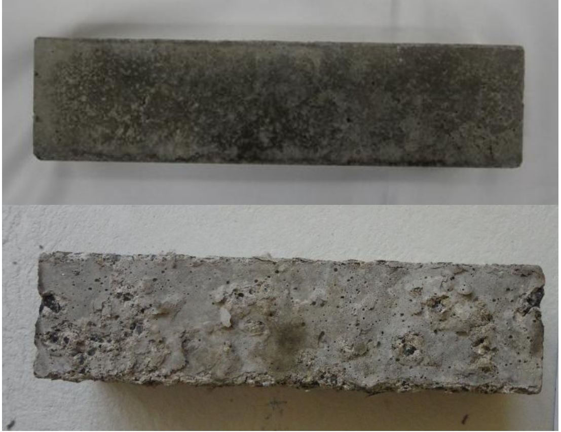
Şekil Ek. 13: B250+50 Numunesine ait magnezyum sülfat etkisinden önceki ve sonraki görüntüler
