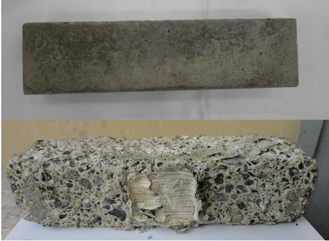
Şekil Ek. 11: A200+120 Numunesine ait magnezyum sülfat etkisinden önceki ve sonraki görüntüler
