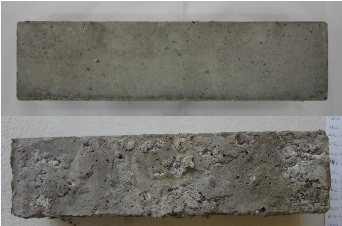
Şekil Ek. 16: K250+90 Numunesine ait magnezyum sülfat etkisinden önceki ve sonraki görüntüler
