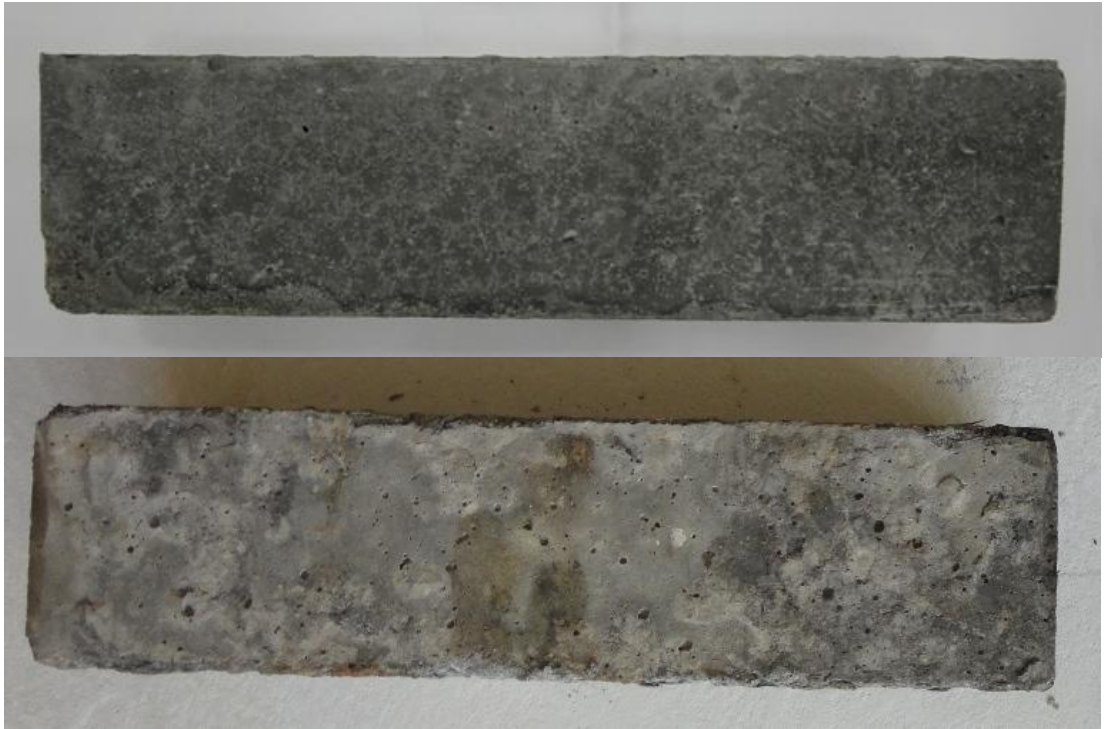
Şekil Ek. 14 : C250+90 Numunesine ait magnezyum sülfat etkisinden önceki ve sonraki görüntüler
