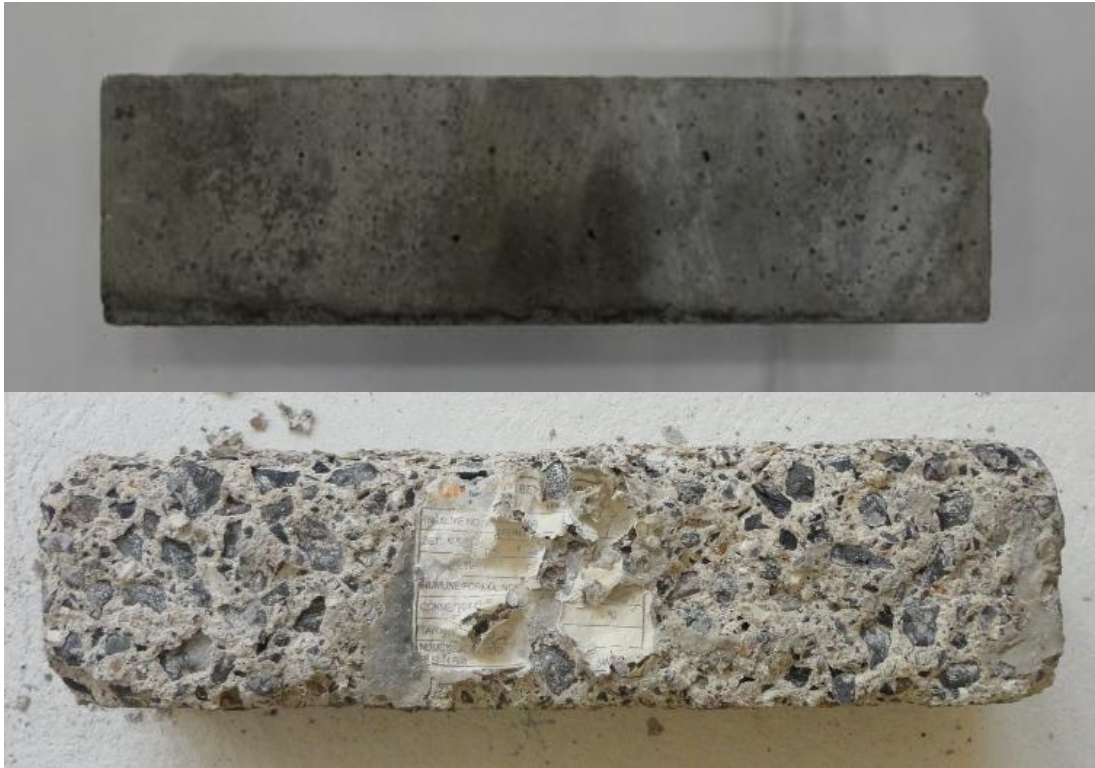
Şekil Ek. 12: B200+100 Numunesine ait magnezyum sülfat etkisinden önceki ve sonraki görüntüler
