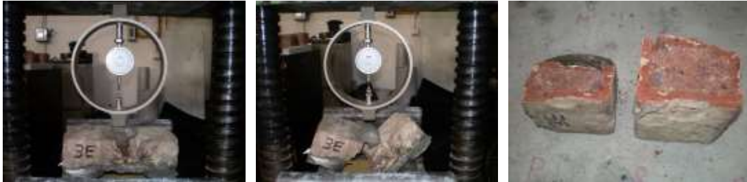
Şekil 2.11 : Tuğla eğilme deneyinde hasar gelişimi.
