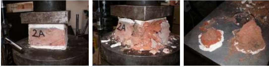
Şekil 2.8 : Tuğla basınç deneyinde hasar gelişimi.
