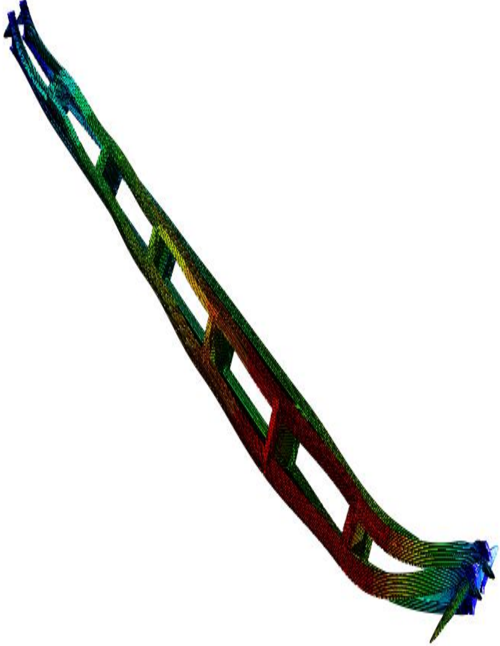
Şekil 5.19 : Açıklığın yedide birinden bağlanmış çift I enkesitli çok parçalı kiriş için yanal burulmalı burkulma.
