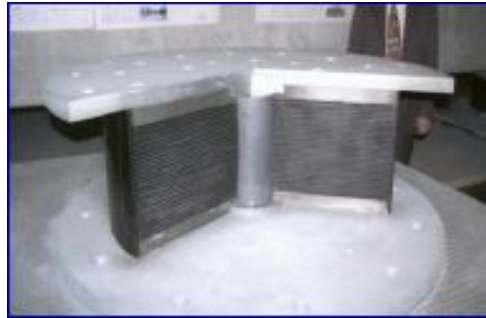
Şekil 2.21: Kurşun çekirdekli kauçuk mesnet kesiti (Yücesoy, 2005).
