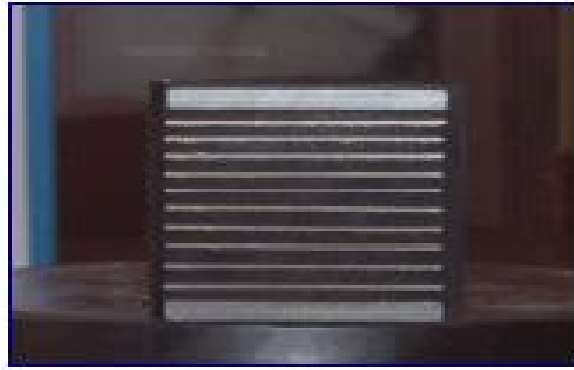
Şekil 2.17: Düşük sönümlü kauçuk mesnetin enkesiti (Coşkun, 2004).
