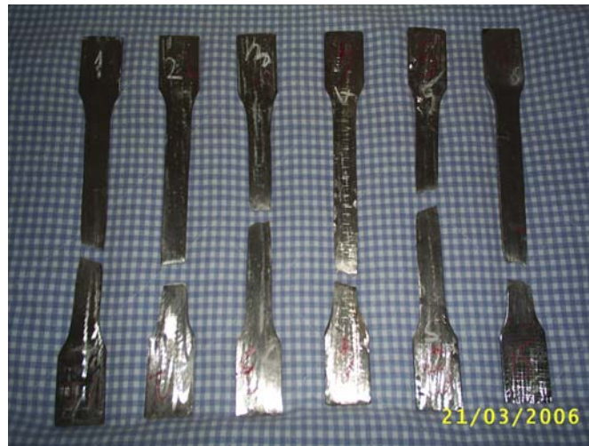
Şekil 4.3: Çekme deneyine tabi tutulan lamalar
