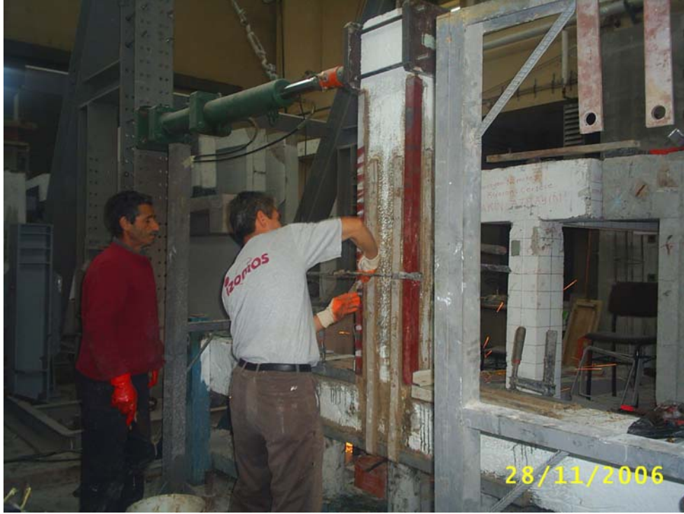
Şekil 3.8: Çelik elemanlarla güçlendirme uygulaması
