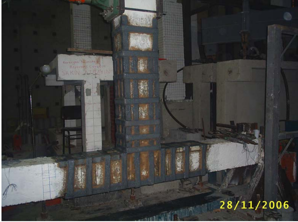
Şekil 5.5: Hasar görmüş tip 1 numunesi güçlendirilmiş hali ( GTip 1 numunesi)
