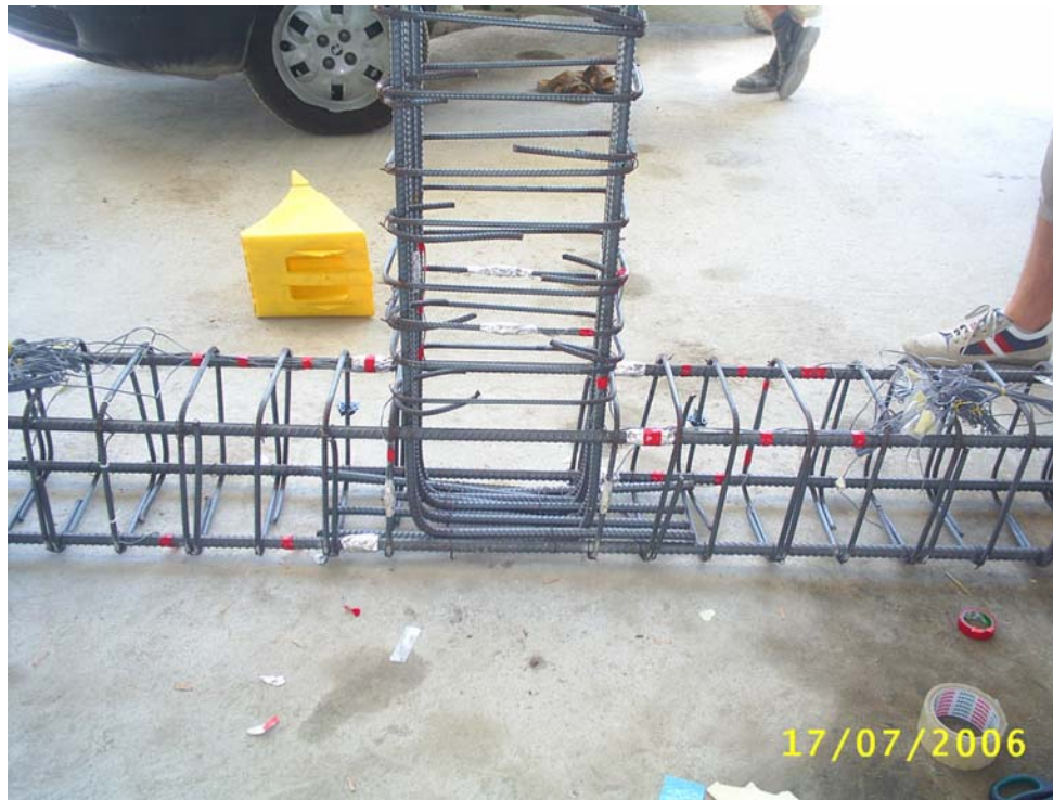
Şekil 4.11: Deney numunesinde şekil değıştirme ölçer yerleřimi
