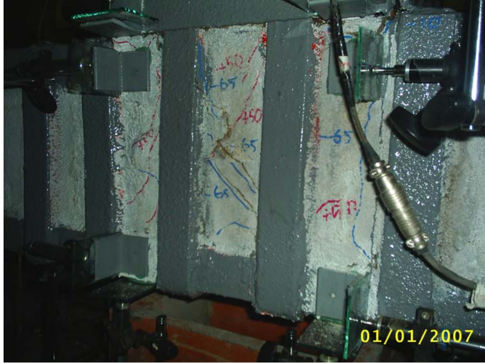
Şekil 5.6: GTip 1 numunesi deney sonu çatlak krokisi
