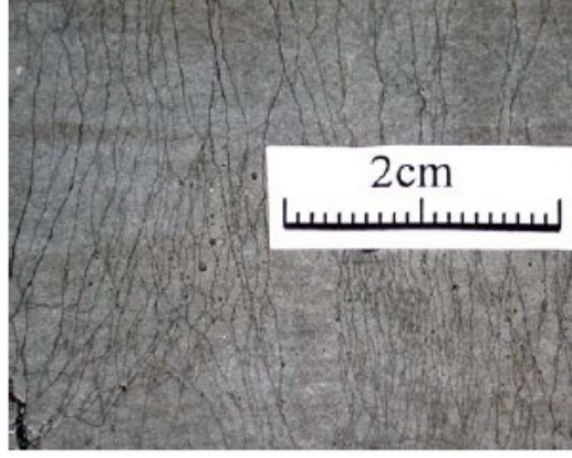
Şekil 2.4 : PVA lifli çimento esaslı kompozitte eksenel çekme altında birçok küçük çatlak oluşumu [20].
