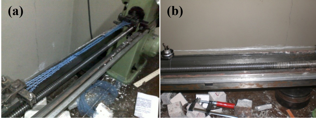
Şekil 3.16 : Çekme deneyi kurulumu: a) PET kumaş ve çeneler, b) Lif ve makara.
