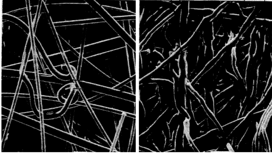
Şekil 2.11 : Nonwoven web (tülbent) yapısı (sol), kalenderleme yöntemiyle bağlanmış nonwoven yapısı (sağ) [38].
