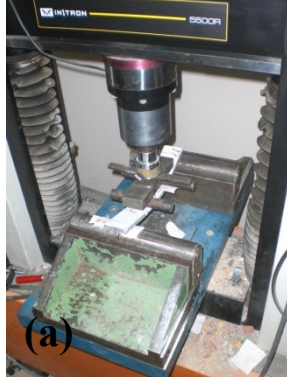
Şekil 3.17 : Eğilme deneyi kurulumu: a) Sistem düzeneği, b) Temsili mesnetler.
