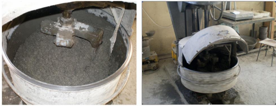
Şekil 2.7 : Beton silindirlerin imalatı.
