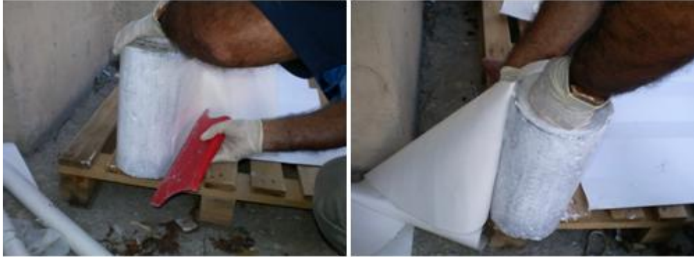
Şekil 3.1 : Silindir sargılama işlemi.
