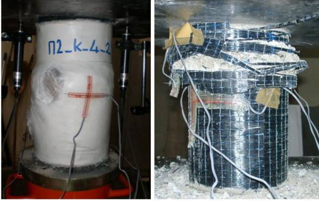
Şekil 1.2 : Yavaş yavaş göçen (solda) ve ani (sağda, Koç, 2004) olarak kırılan sargılı beton davranışı
