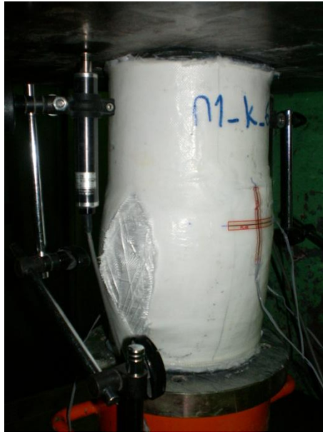
Şekil 3.7 : 6 kat sargılanmış hasarlı numune.
