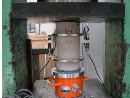
Şekil 2.12 : Tek eksenli basınç deneyi düzeneği.
