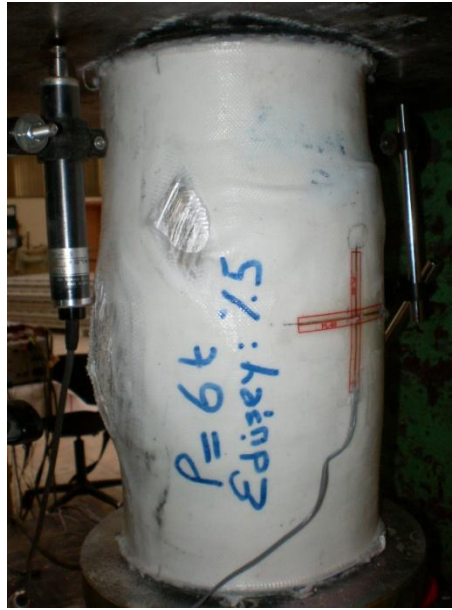
Şekil 3.5 : %5 şekildeğiştirme yapmış hasarlı numune.
