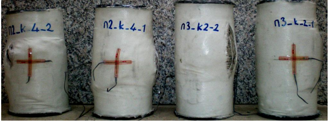
Şekil 3.6 : 4 kat ve 2 kat sargılanmış hasarlı numuneler.
