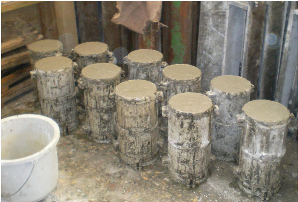
Şekil 2.8 : Kalıplara dökülmüş beton silindir numuneler.
