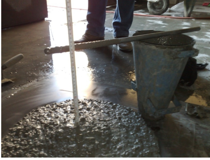
Şekil A.25 : Çökme kontrolü deneyi.
