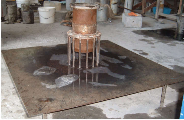
Şekil 4.3: kısıtlanmış yayılma deney düzeneği
