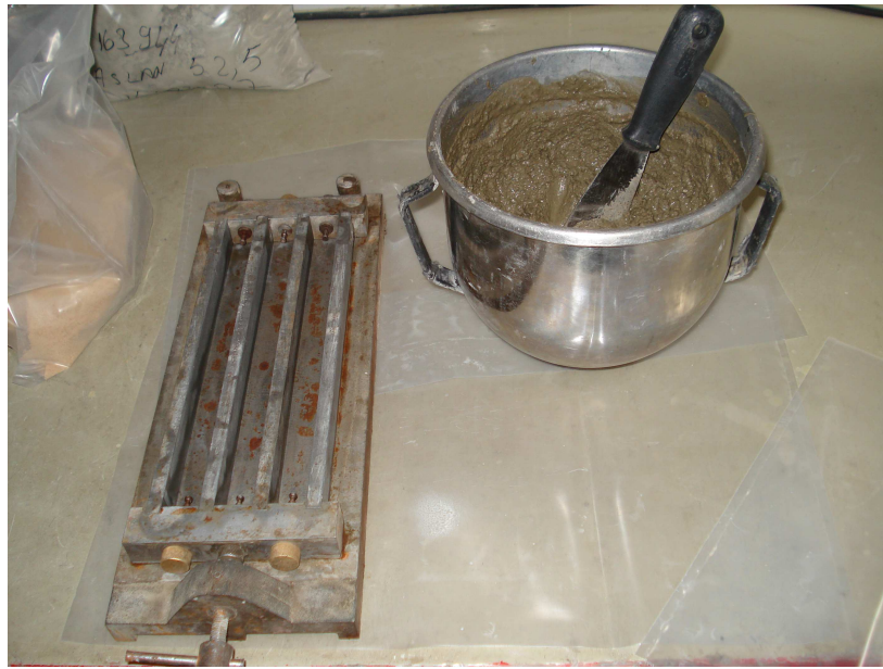
Şekil 3.11; R tre Kalıbına Pimlerin Montajı Sonrası G r nt 
