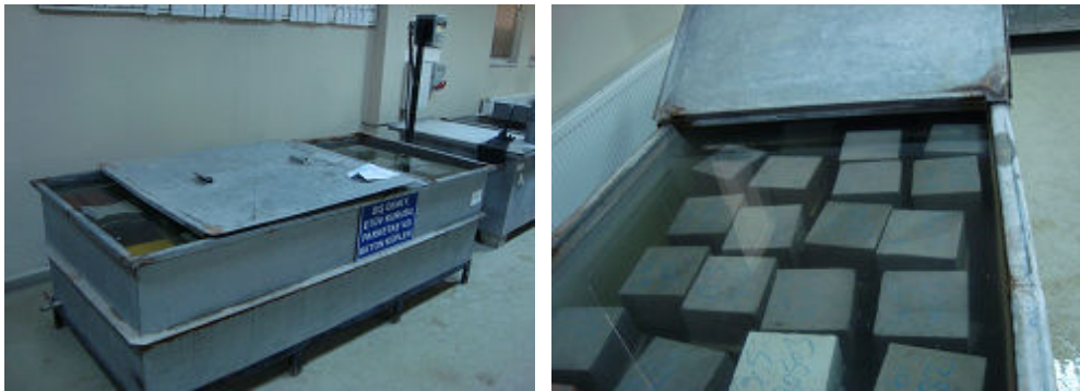
Şekil 5.7 : Kür havuzu ve kalıptan çıkarılan numunelerin kür edilmesi.
