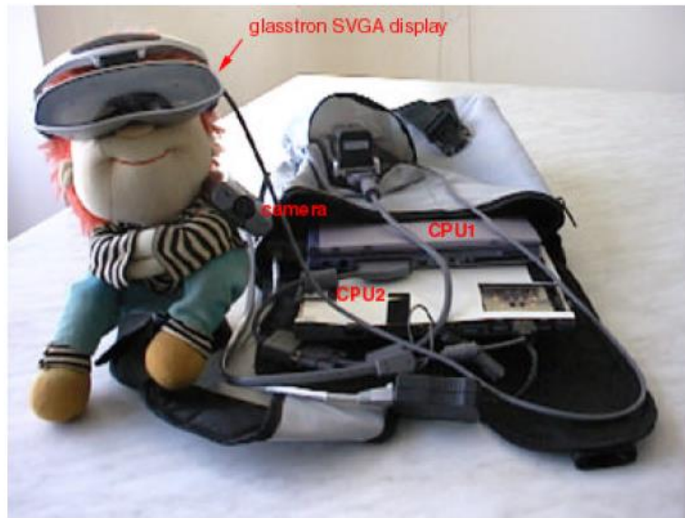
Şekil 4.8: Giyilebilir Sinema donatısı – sırt çantası, iki CPU, kamera, gözlükler
