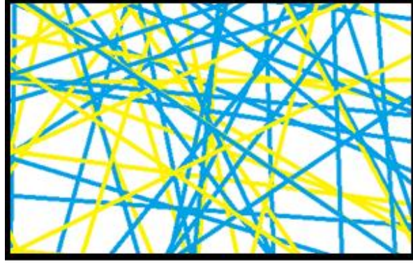
řekil 1.3 : alıřma kapsamında elde edilmesi planlanan nanofiber yapı (sarı renkte olanlar PAN, mavi renkte olanlar PSU nanofiberlerini temsil etmektedir).
