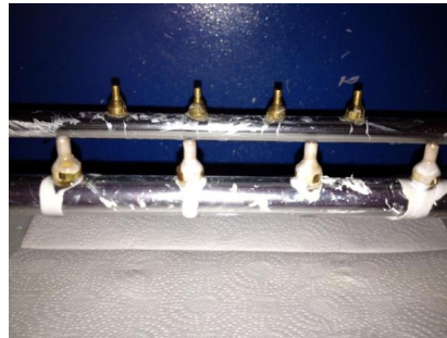
Şekil 3.4 : İğnelerin ucunun donması durumu.
