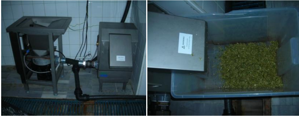
Şekil 4.17: Susuzlaştırma makinesi ve organik atığın susuzlaşmış hali.
