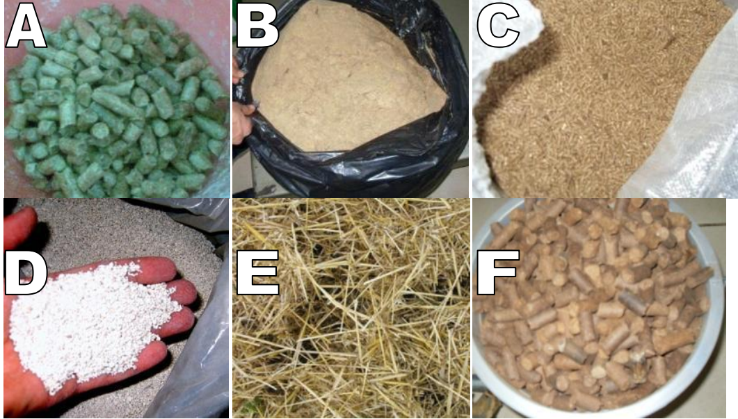
Şekil 4.20: Kullanılan farklı katkı maddelerinin görünümü A-Sıkıştırılmış Odun Talaşı, B-Odun Talaşı, C-Buzağı Yemi (İçerik Selüloz ve Bitkisel Protein), D-Zeolit, E-Saman, F- Meşe Talaşı Peleti.
