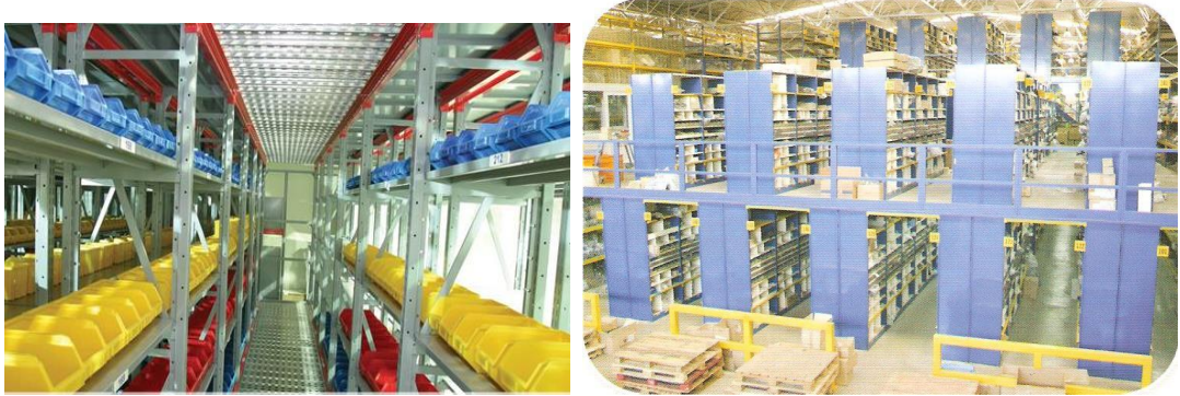
Şekil 3.17 : Mezanin tip raf sistemleri örnekleri (Hopbaoğlu, 2009; Tezcan, 2007).
