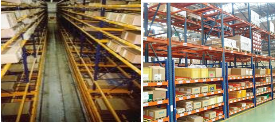
Şekil 3.16 : Kutulu kayar raf sistemleri örnekleri (Hopbaoğlu, 2009).
