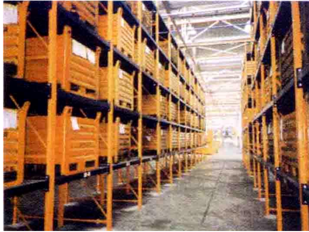
Şekil 3.9 : Tek paletli raf sistemleri örneği (Hopbaoğlu, 2009).
