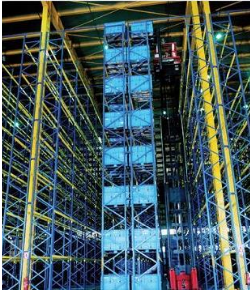
Şekil 3.14 : Dar koridorlu depolama sistemleri örnekleri (Hopbaoğlu, 2009).
