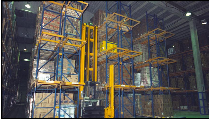
Şekil 3.20 : Dar koridor raf sistemleri örneği (Tanyaş,2011).
