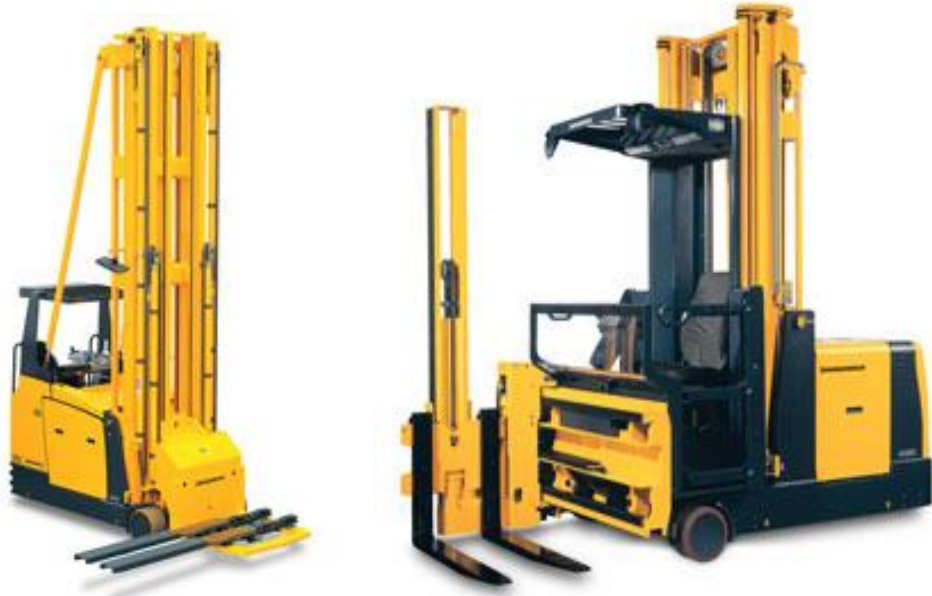
Şekil 3.26 : Dar koridor istif makinaları (Hopbaoğlu, 2009).
