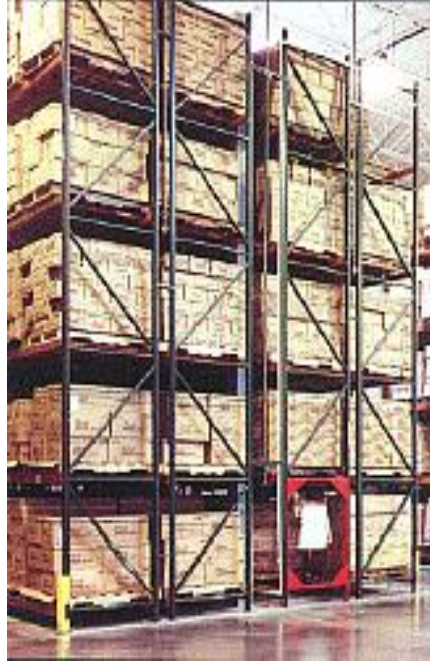
Şekil 3.8 : İkili derinlikli raf sistemleri örneği (Hopbaoğlu, 2009).
