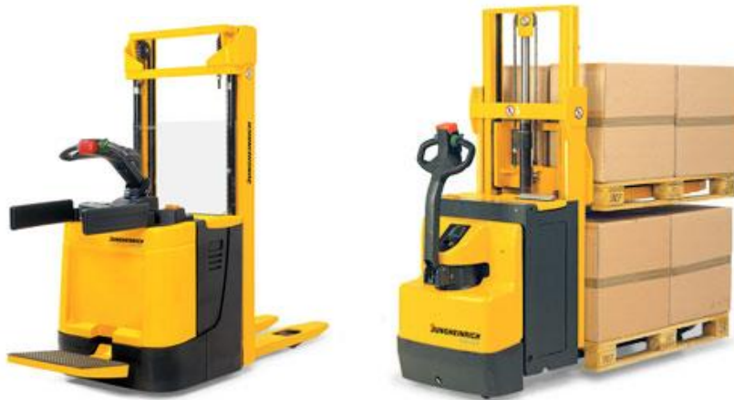
Şekil 3.28 : Elektrikli istif makinaları (Hopbaoğlu, 2009).
