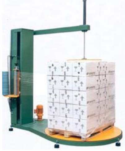
Şekil 3.32 : Streçleme makinası (Hopbaoğlu, 2009).
