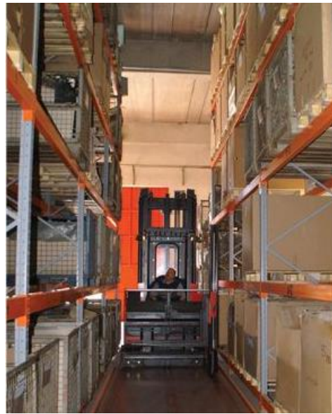
Şekil 3.14 : Dar koridorlu depolama sistemleri örnekleri (Hopbaoğlu, 2009).
