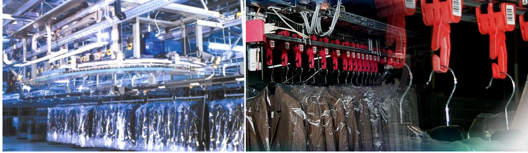
Şekil 3.15 : Askılı konveyör depolama sistemleri örnekleri (Hopbaoğlu, 2009).
