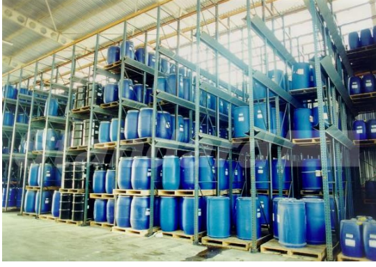
Şekil 3.10 : İçine girilebilir ve içinden geçişli raf sistemleri (Hopbaoğlu, 2009).
