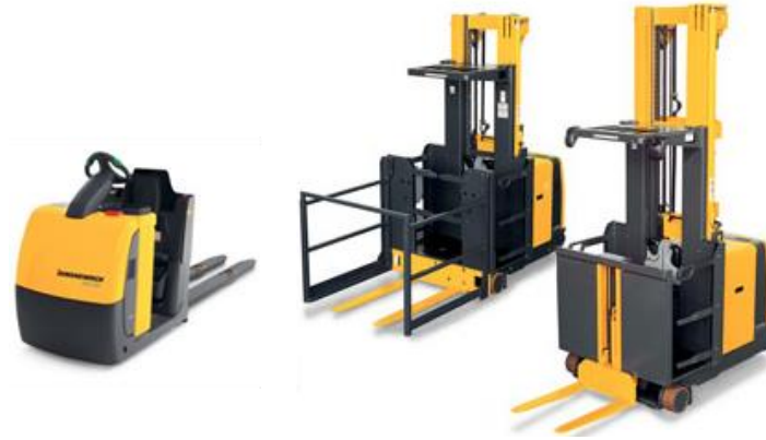
Şekil 3.27 : Sipariş toplama araçları (Hopbaoğlu, 2009).
