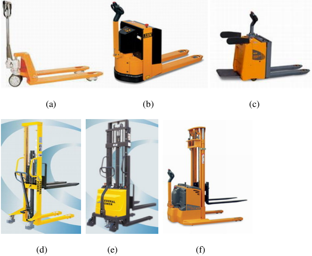
Şekil 4.4 : Transpalet ve istif araçları: (a) transpalet, (b) akülü transpalet, (c) akülü transpalet-platformlu, (d) manüel istif aracı, (e) yarı manüel istif aracı, (f) akülü istif aracı (Url-6).
