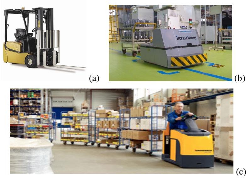
Şekil 4.5 : (a) Forklift (Url-7), (b) otomatik yönlendirmeli araç (Url-8), (c) kısa tren (Url-9).
