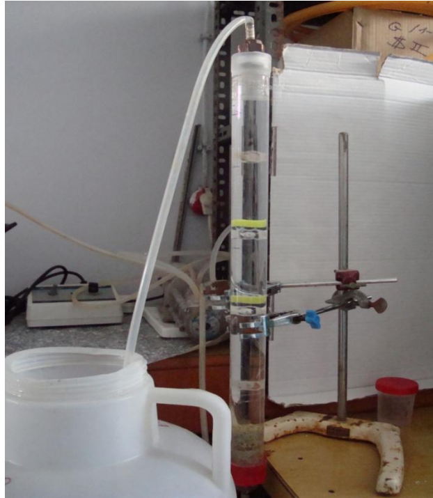
Şekil 4.2: Klinoptilolit yüzeyindeki besi maddelerinin desorpsiyonla geri kazanımı deneyi.
