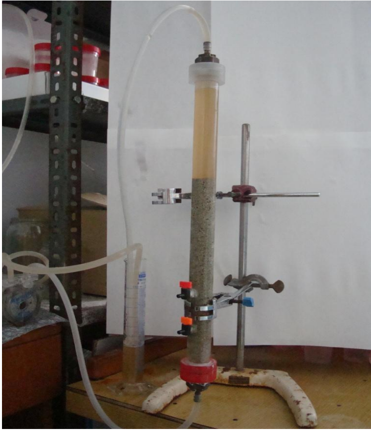
Şekil 4.1: %100 geri devirli kolonda klinoptilolit yüzeyine idrardaki besi maddelerinin yüklenmesi deneyi.
