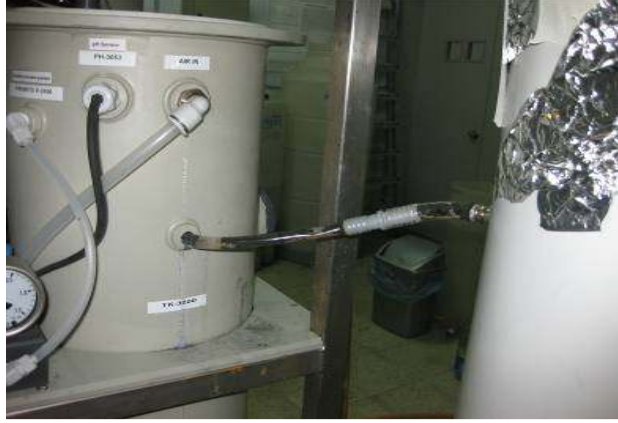
Şekil 3. 13 : 1,5 tonluk hamsu tankından I. Reaktöre otomatik olarak su beslemesi yapan pompa
