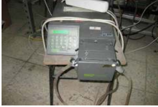
Şekil 3. 13 : 1,5 tonluk hamsu tankından I. Reaktöre otomatik olarak su beslemesi yapan pompa
