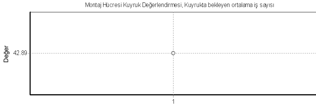
Şekil 7.65 : Seçenek 2: Montaj hücresi kuyrukta ortalama bekleyen iş sayısı
