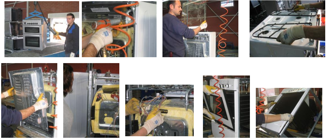
Şekil 2.8: Fırın Demontaj Operasyonları
