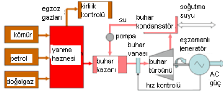
Şekil 3.4 : Fosil yakıtlardan elektrik enerjisi üretimi[39].
