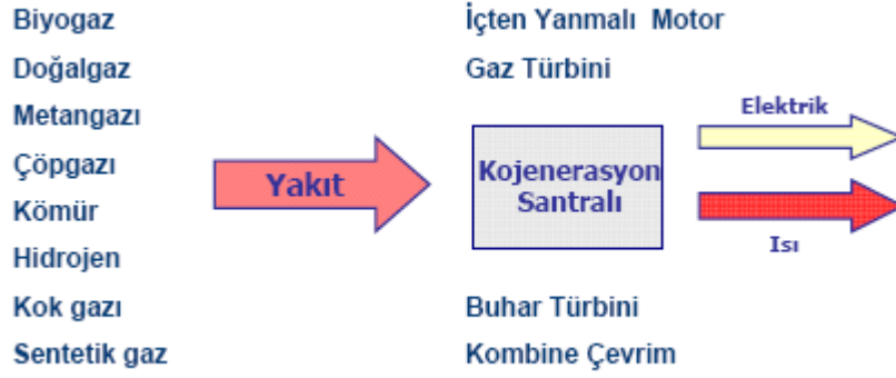
Şekil 3.5 : Birleşik ısı ve güç enerjisi teknolojisi ile elektrik üretim akışı [44].
