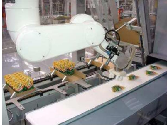
Şekil 8.1: Gıda sektöründe “alıp yerleştirme” uygulaması örneği.
