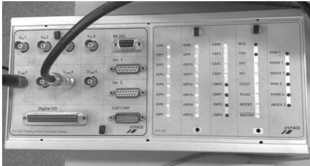
Şekil 2.6 : DS1102 kontrolörün yapısı.
