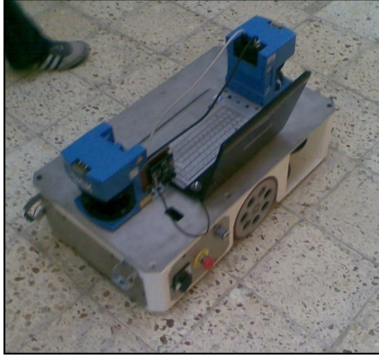
Şekil 2.4 : Mobil Robottaki 2 SICK LMS200'ün yerleşimi
